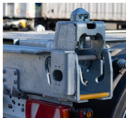
Der höhenverstellbare STEP LOCK® am Heccausschub erlaubt mit zwei Handgriffen die Aufnahme von 40' und 45' Containern ohne Tunnel.
