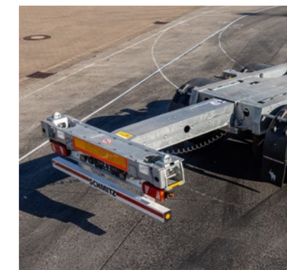
Neu: Gedämpfter Heccausschub fährt pneumatisch die gewählte Verriegelungsposition an und bremst sanft ab.
