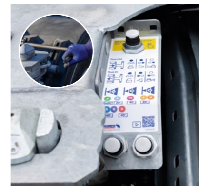
Steuerung für pneumatische Verriegelung für den Heccausschub, optional mit manueller Verriegelung*.
