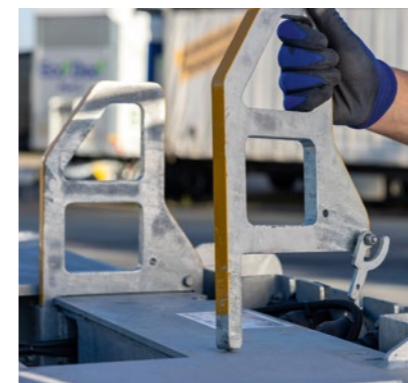
Leicht auswechselbare Containerführungen für Container am Frontbalken.
