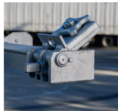
Klappverriegelung als PIN-Verriegelung für Tunnelcontainer am Frontbalken.
