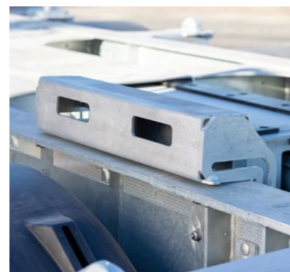
Drei Paar klappbare Containerauflagen* für Container ohne Tunnel.
