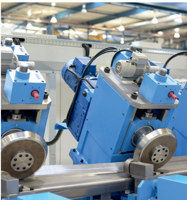
In der Rollieranlage wird der Langträger bei Raumtemperatur durch schwenkbare Walzen in seine exakte Form gebracht.
