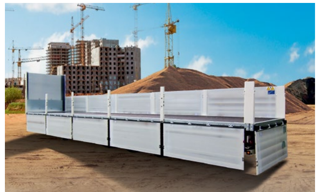
Abklappbare Bordwände und demontierbare Steckungen für volle seitliche Durchladebreite.
