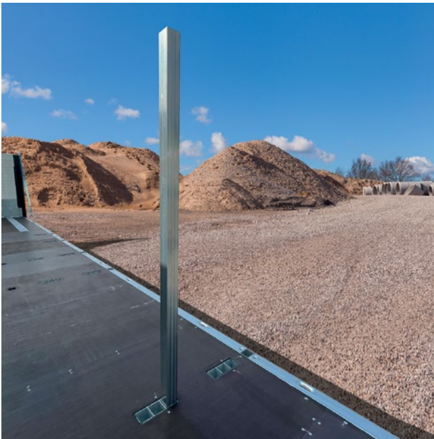
Feuerverzinkte Rungentaschenmagazine im Fahrzeugboden bieten für die Anordnung von Steckstützen viele Möglichkeiten.
