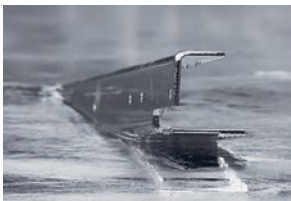
Erst das fertig bearbeitete Werkstück wird in das Zinkbad getaucht. Durch dieses Stückverzinken sind Schnittkanten und Hohlräume genauso geschützt wie die großen Außenflächen.
