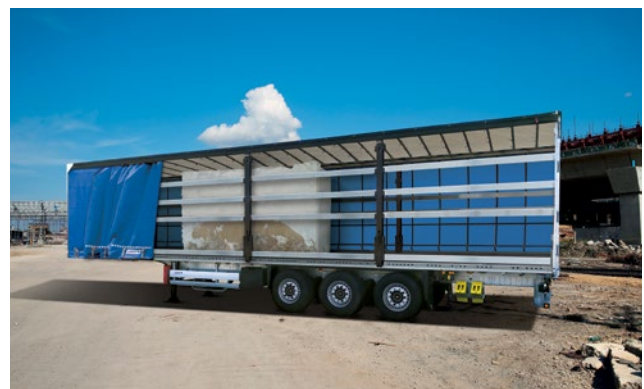
Bei hohen Punktbelastungen kann das verstärkte Bau-Chassis auch mit einem S.CS Planenfahrzeug kombiniert werden.
