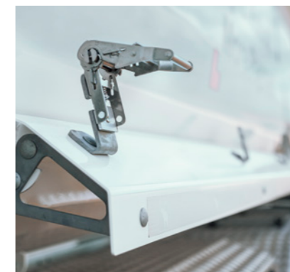
Seitliche Abweiserbleche zum Schutz vor herabfallendem Schüttgut beim Be- und Entladen. Ratschen für die Planenabspannung.
