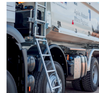
Umfangreiche Zusatzausstattungen optional wählbar: z.B. seitliche Aufstiegsleiter für die Ladungskontrolle.
