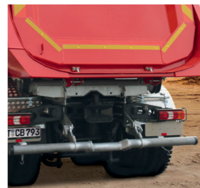
Gekröpfter klappbarer Unterfahrerschutz (optional) für Fahrzeuge mit Anhängerkupplung.
