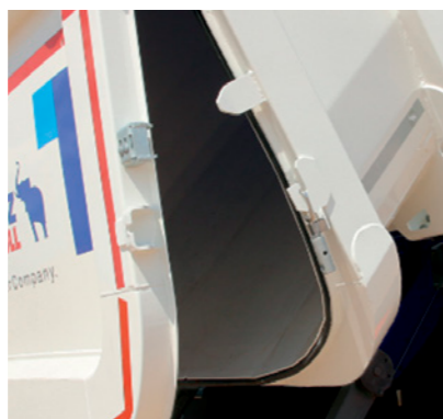
Aufliegende Rückwandklappe mit umlaufender Gummidichtung.
