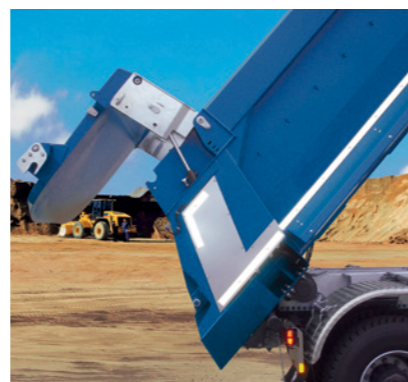
Hydraulische Rückwand: Ideal für grobe Schüttgüter.
