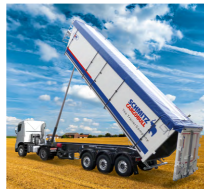
Lona enrollable de nuevo diseño para un manejo más sencillo. El cierre se realiza mediante una cinta tensora central.
