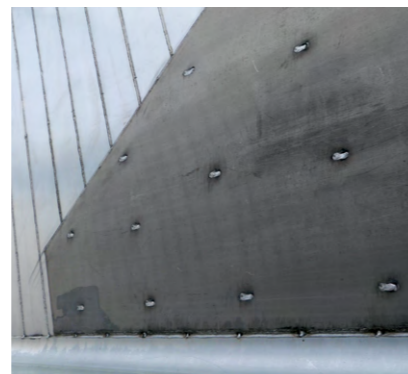
Las chapas de desgaste adicionales en la parte trasera prolongan la durabilidad de la caja.
