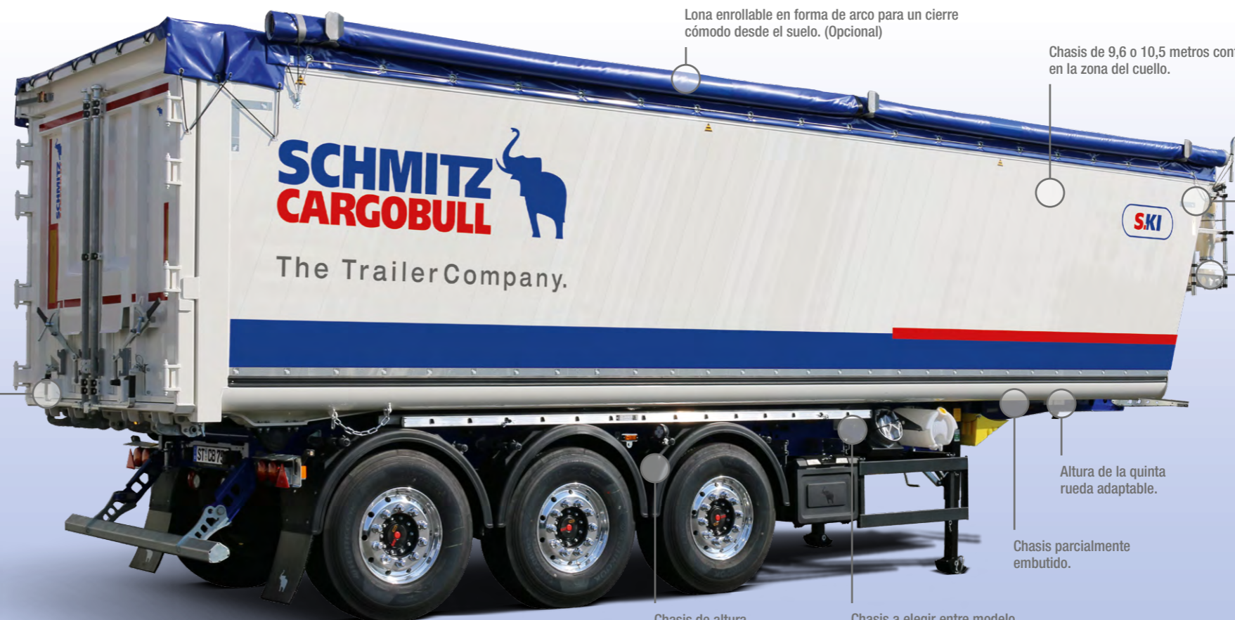
Lona enrollable de nuevo diseño para un manejo más sencillo. El cierre se realiza mediante una cinta tensora central.
