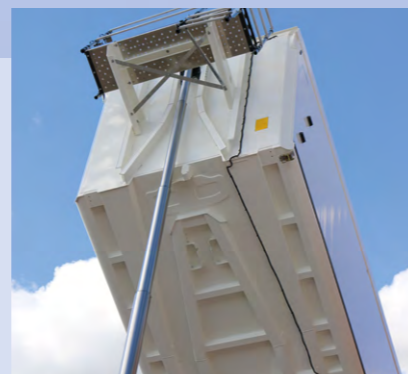
Zona del cuello parcialmente empotrada en la parte inferior de la carrocería para una altura más reducida.
