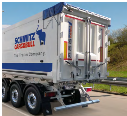
Puerta combinada con marcos basculantes, 2 hojas y 2 trampillas de cereales.
