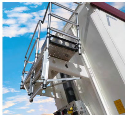
Plataforma de trabajo ajustable en altura fijada directamente a la caja para proporcionar una estabilidad óptima al manipular la lona.
