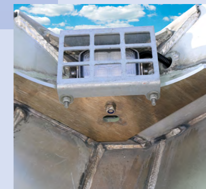
La iluminación interior facilita la limpieza y el manejo de mercancía con la lona cerrada.
