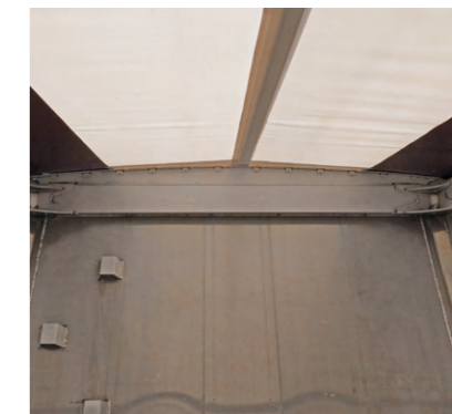
El diseño arqueado de la lona enrollable con el tubo central estabilizador evita las acumulaciones de agua.
