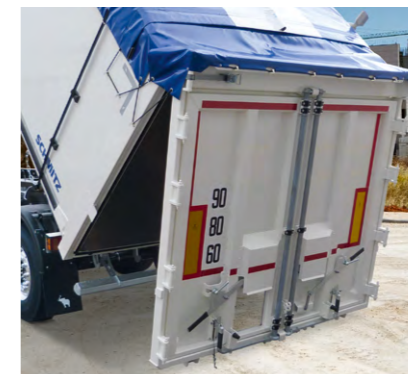
Posibilidad de descarga con lona cerrada mediante la función basculante de la puerta combinada, esto ahorra tiempo al descargar.
