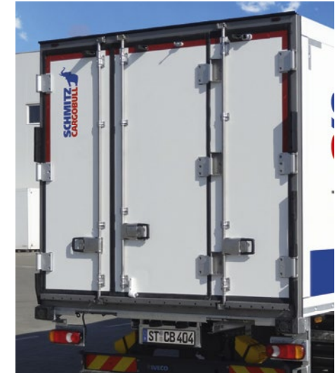
Drei-flügeliges Heckportal mit Mitteltür für die gezielte Teilöffnung, um den Kälteverlust beim Be- und Entladen zu reduzieren.
