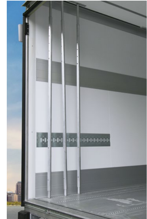
Schnell zur Hand und einfach bis zum Einsatz gesichert – das seitliche Sperrstangenmagazin.
