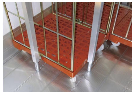
Airline-Schienen in Decke und Boden vereinfachen durch formschlüssige Arretierung die Ladungssicherung mit senkrechten Teleskopbalken.
