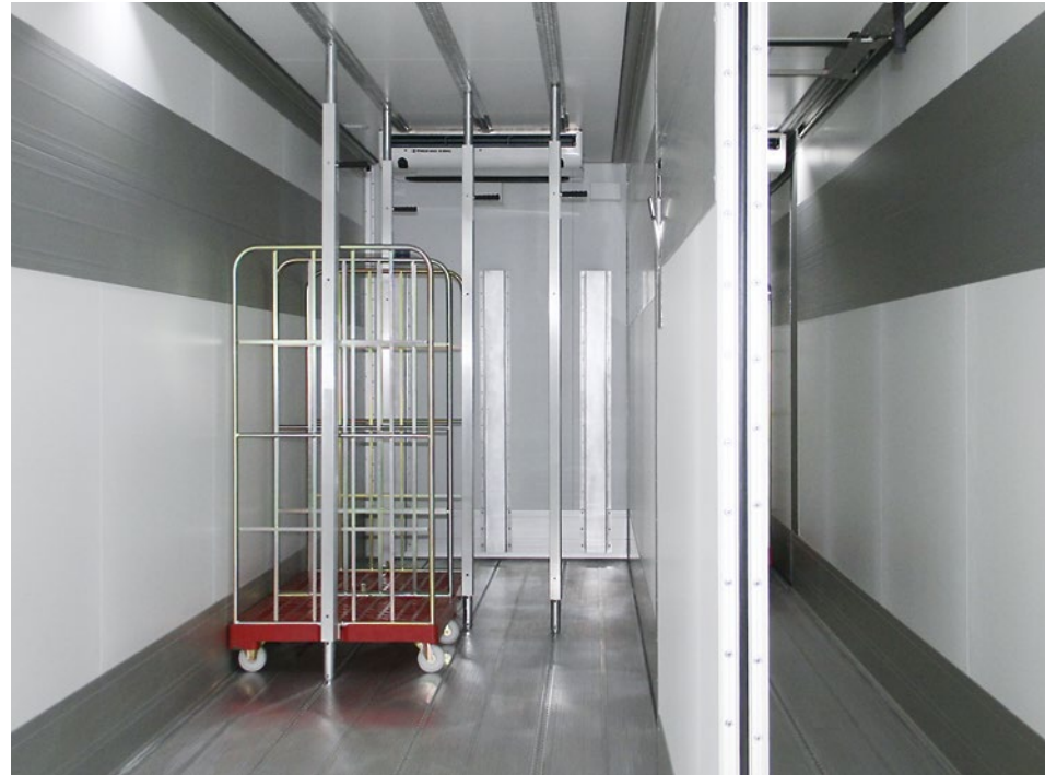
Senkrechte Teleskopbalken mit speziellem Fuß für den Multifunktionsboden zur Ladungssicherung.
