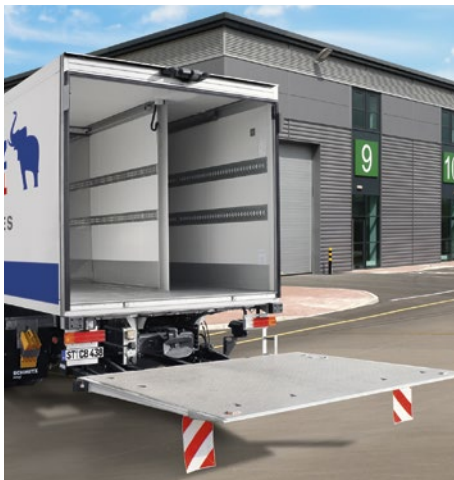
Ladebordwand als isolierte Heckklappe beschleunigt das Be- und Entladen durch den direkten Zugang zur Fracht.
