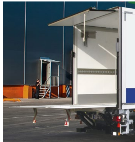
Isolierte Ladebordwand in Kombination mit einer Klappe an der Oberkante des Aufbaus ersetzt das zwei-flügelige Heckportal.
