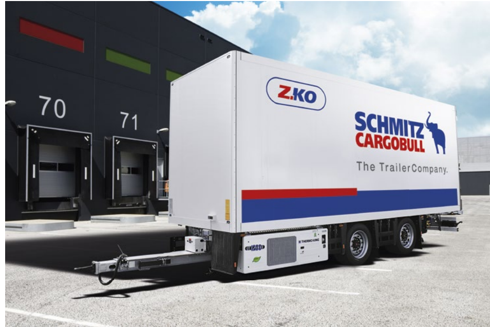
Volle Raumnutzung: Tiefgekuppelter Zentralachsanhänger mit Unterflurkühlgerät. Gleichzeitig ist der Zentralachsanhänger sehr wendig. Die besondere Achsstellung vereinfacht rückwärtiges Rangieren.
