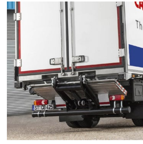
Die unterfahrbare Ladebordwand erlaubt das direkte Andocken an den Klimaschürzen der Rampe ohne Temperaturverlust.
