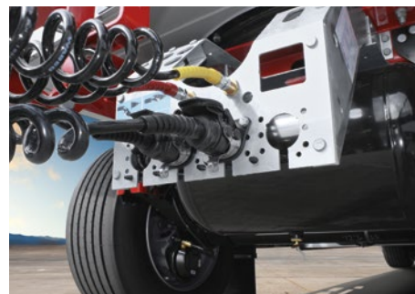
Anschlussleiste für Luft und Elektrik zentral unterhalb der Zuggabel.
