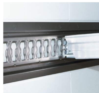
Ladungssicherungsschiene erlaubt freie Positionierung der Ladungssicherungsbalken auf ganzer Länge.
