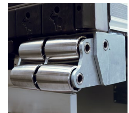
Kompressibler Rollenrampuffer (DRP)* mit reparaturfreundlichem, modularem Aufbau schützt das Heck bei der Anfahrt an der Rampe.
