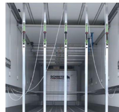
Senkrechte Teleskopbalken* einfach und schnell im Multifunktionsboden zur Ladungssicherung fixiert.
