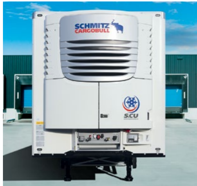
Zuverlässige Transportkältemaschine S.C.U in drei Versionen für jeden Einsatzzweck – mit sehr präziser Temperaturführung, besonders sparsam im Teillastbetrieb.
