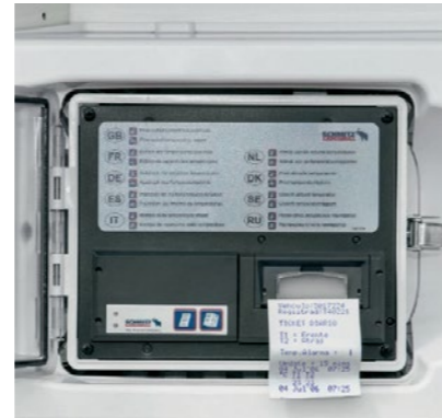
Einfach zu bedienender Temperaturdrucker* an der Stirnwand als kosteneffiziente Ergänzung zum ab Werk verbauten digitalen Temperaturrekorder.
