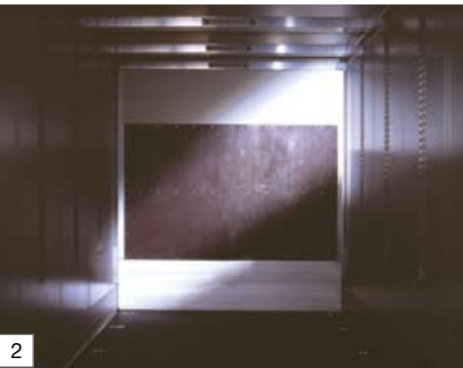
2 Stirnwand mit Holzverstärkung
