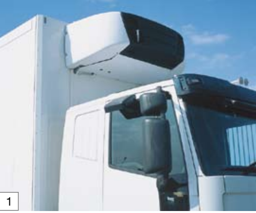
1 Vorbereitet für Kühlgeräte
