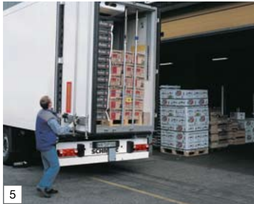
Türflügel um 270° schwenkbar
