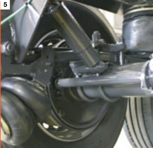
5. Elevador de eje automático, sube y baja según la carga.
