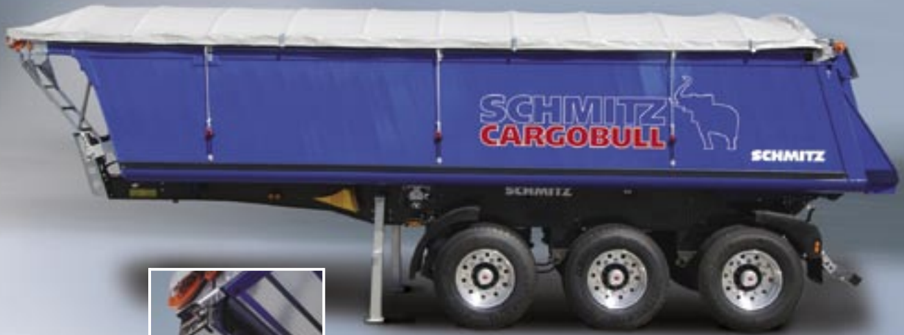
1. Techo corredizo alternativamente con accionamiento mecánico (imagen 1) y eléctrico (imagen 2).
