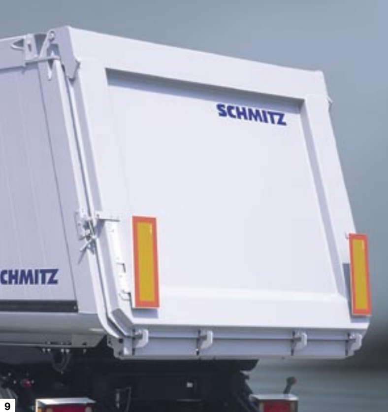
9. Puerta basculante sobrepuesta para bañera cuadrada de aluminio, hermética gracias a una pestaña en el perímetro de la puerta, cuatro uñetas de cierre y dos cierres laterales (tipo palometa) de seguridad.
