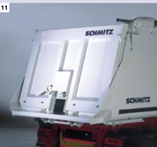
11. Puerta basculante para la bañera cuadrada de aluminio con trampilla de cereales y trampilla de cereales.
