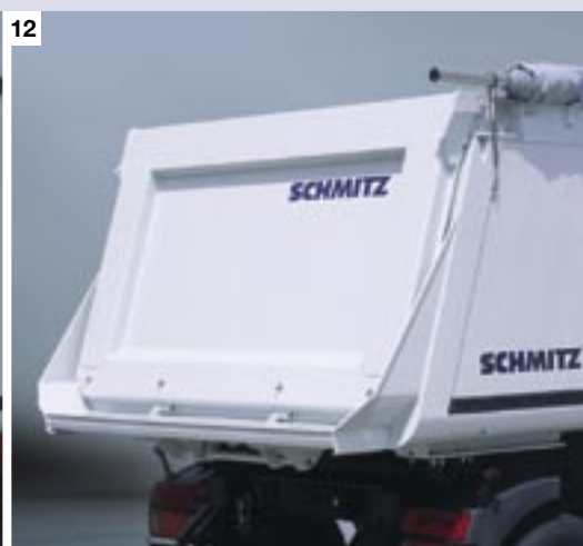
12. Puerta basculante para la bañera cuadrada de aluminio con vertedero.
