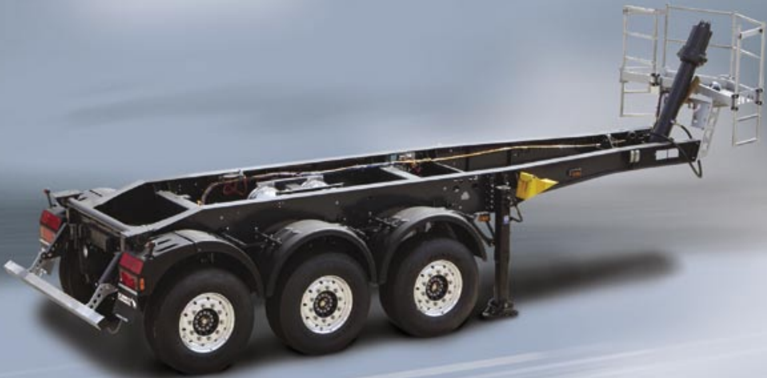
11. Chasis en construcción optimizada en peso con sección de quinta rueda recogida y parte trasera híbrida.
