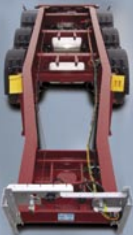
12. Chasis en construcción optimizada en peso.
