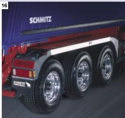
16. Guardabarros monocasco, diseño Schmitz Gotha, con cubierta de acero inoxidable.
