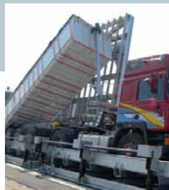
Benne sur le banc d'essai.
