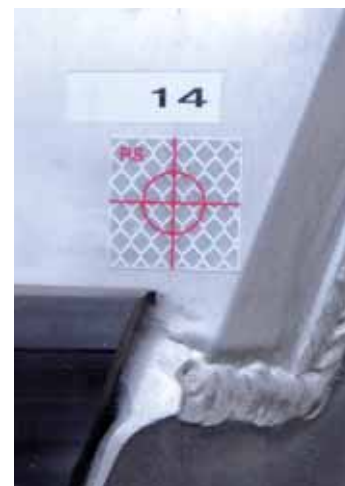
Point de mesure sans contact sur la caisse au banc d'essai.
