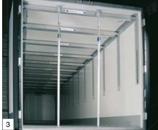
3 Barres télescopiques, avec butée caoutchouc des deux côtés
