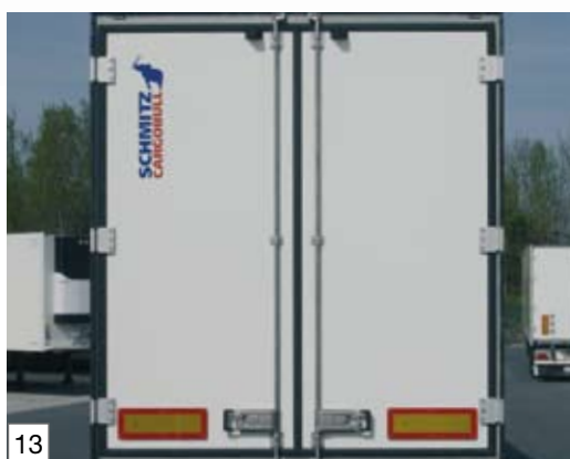
Portes arrière en FERROPLAST®
