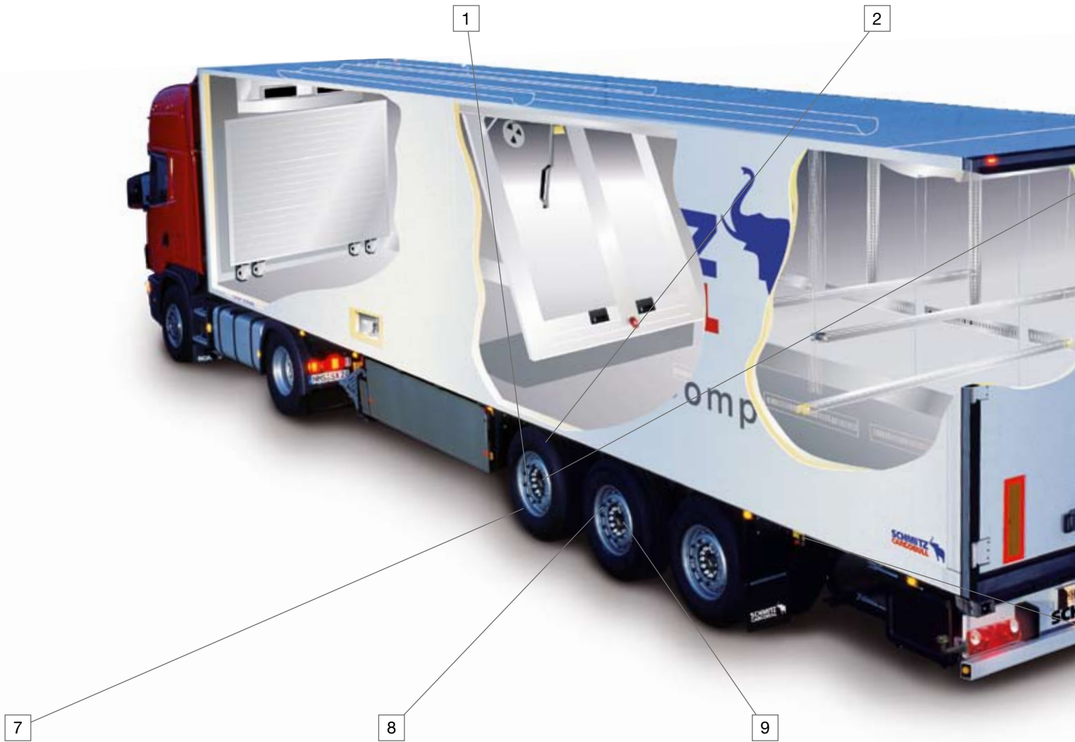
Essieu relevable, monte et baisse automatiquement
