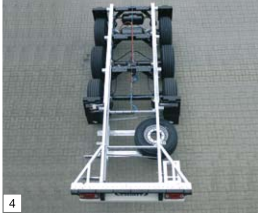
Châssis court galvanisé
