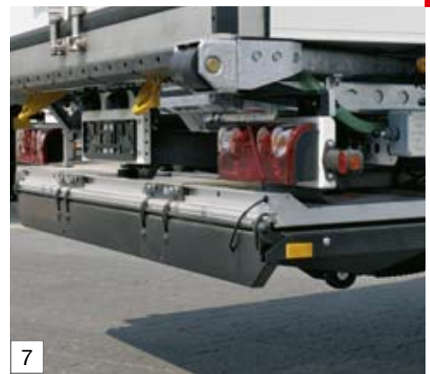
Hayon de chargement rétractable (version Schmitz Cargobull)
