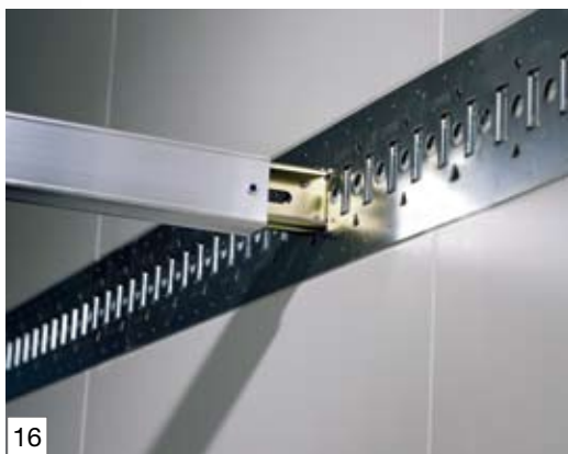
Rails d'arrimage de la marchandise dans les panneaux latéraux
