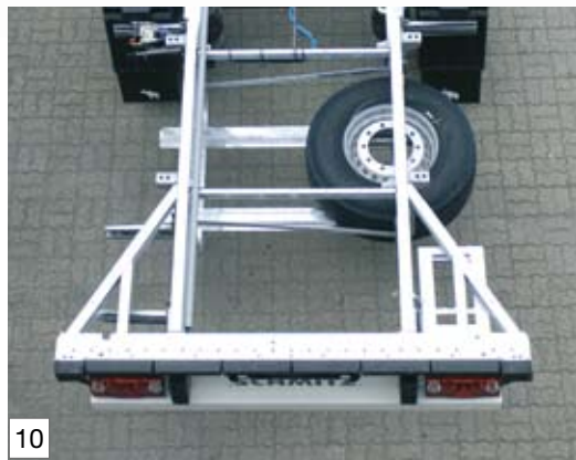
Traverse arrière avec renforts diagonaux
