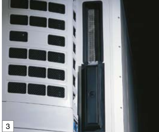
Clapet de ventilation à côté du groupe frigorifique
