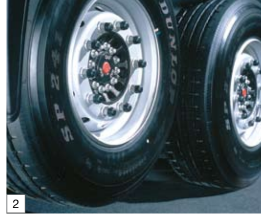
Essieu relevable, monte et baisse automatiquement
