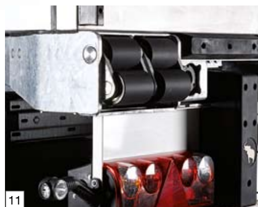
11 Bumper à rouleaux compressibles pour absorption efficace des chocs lors de la mise à quai
