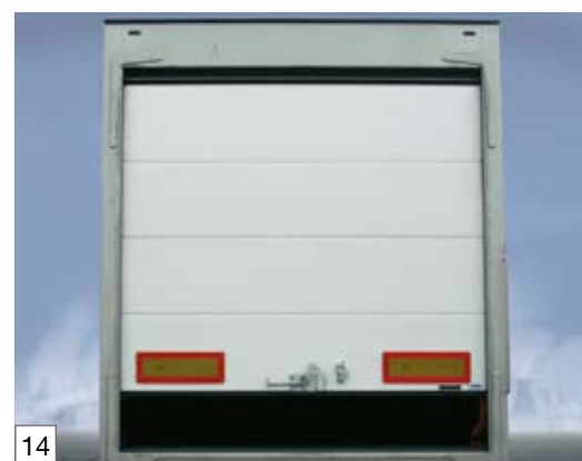
Cadre arrière avec porte à volet roulant
