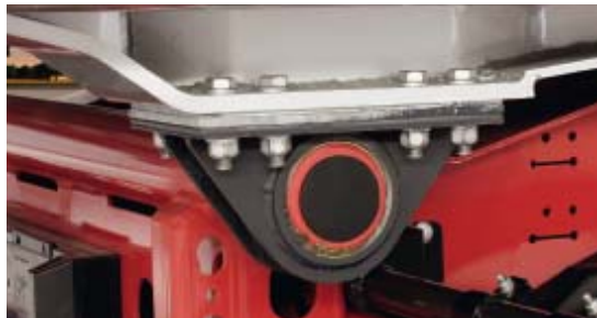
Надежные малообслуживаемые шарнирные опоры ковшовой платформы: ось и втулка значительно увеличены по размеру.
