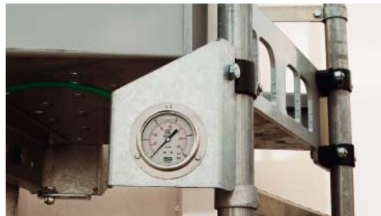
Контроль массы: манометр нагрузки информирует о массе груза и помогает избежать перегрузки.
