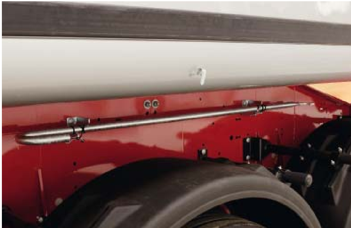
Штанга для манипуляций с тентом установлена в держателе сбоку на шасси.
