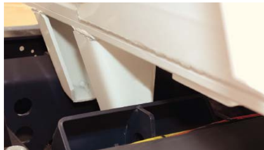
Направляющая центрирует ковшовую платформу при опускании.
