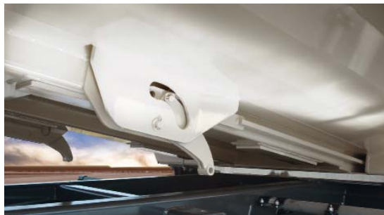
Автоматический механический крюк-запор с двумя запорными штангами.
