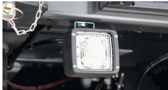
Дополнительный фонарь заднего хода, установленный на поперечине, обеспечивает хорошее заднее освещение при маневрировании.
