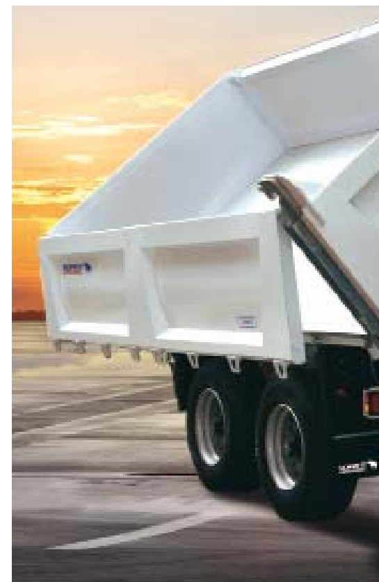
Цельный стальной борт представляет собой прочную конструкцию типа резервуар-мембрана.
