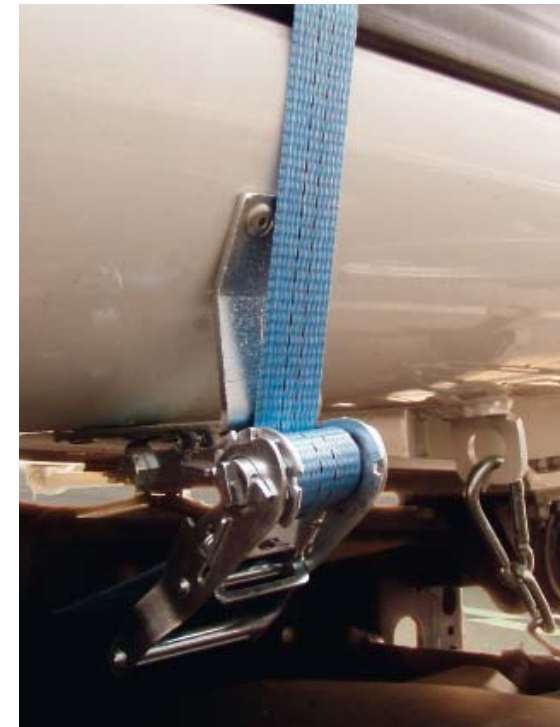
Натяжные ремни и трещотки служат для натяжения свертываемого тента.
