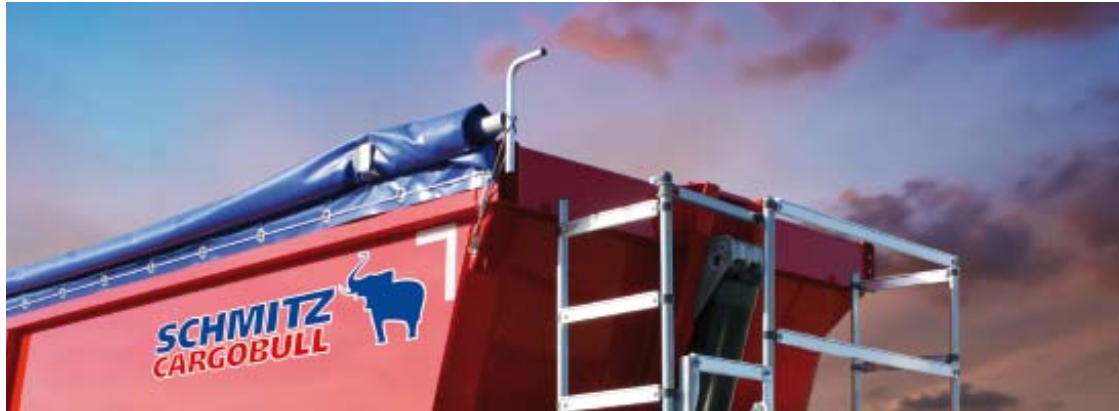
Тент можно свертывать и разворачивать на ковшовой платформе при помощи рукоятки, стоя на рабочей площадке.
