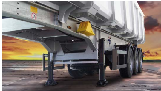
Механический опорный домкрат с выравнивающими подпятниками.
