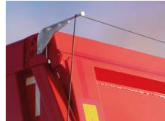
Намоточный профиль упрощает быстрое разворачивание и свертывание тента.
