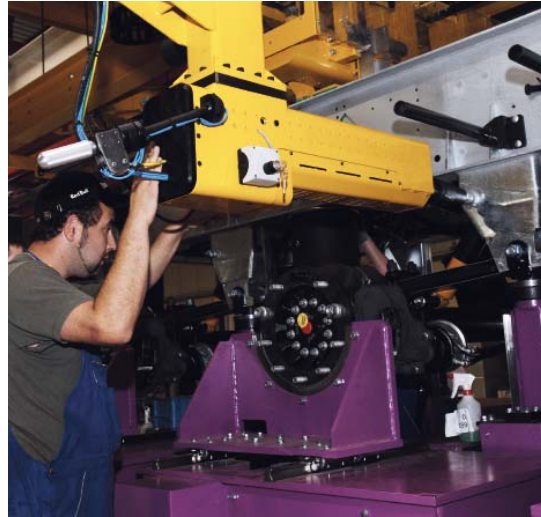
Высокоточный промер кронштейнов крепления оси и осей обеспечивает соосность и щадящее материал безупречное держание колеи.
