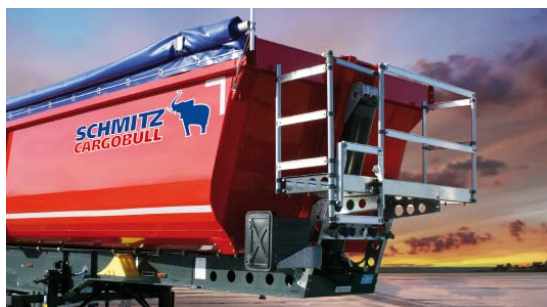
Рабочая площадка с лестницей спереди справа и стремянкой для входа в ковшовую платформу
