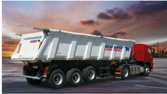
Рама шасси с распределением нагрузки для 2-осевых седельных тягачей (могут использоваться 3-осные седельные тягачи).
