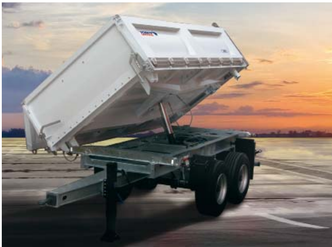
Стальную опрокидывающуюся платформу можно открывать в любую из трех сторон. Пол выполнен из износостойкой стали.
