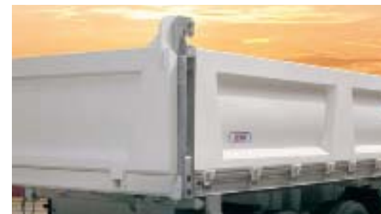
Установленные на болтах угловые стойки из оцинкованной мелкозернистой стали легко регулируются эксцентриком.
