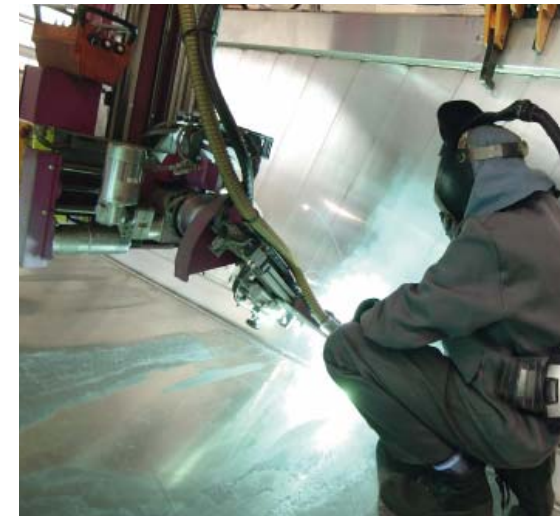
Залог высокой прочности и устойчивости к нагрузкам: автоматическая прецизионная сварка алюминиевых профилей порталной сварочной установкой.
