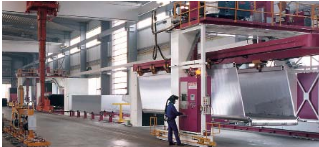
Производство алюминиевых ковшовых платформ на высокотехнологичных производственных линиях: оптимизированные по массе алюминиевые ковшовые платформы строятся из прочных системных профилей.
