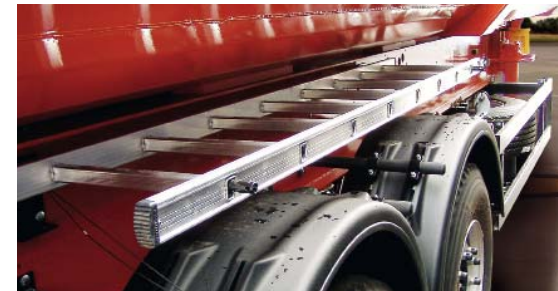
Алюминиевая лестница, установленная на двух вставных опорах над ходовой частью, закреплена и готова к использованию, например, когда нужно подняться для установки тента.
