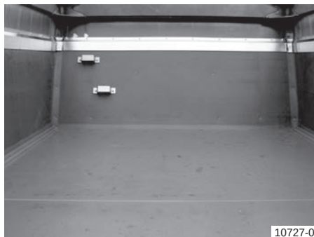
Varianta 2: Výstelka korby, zakrytí boční a čelní stěny cca. 900 mm
