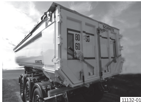
Ocelová kulatá korba s dvoukřídlými kombinovanými dveřmi bez portálového příčného nosníku
