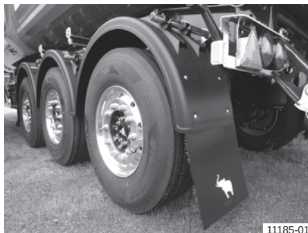
Blatník s lapačem nečistot na zadní nápravě (s ochranou proti rozstříku)
