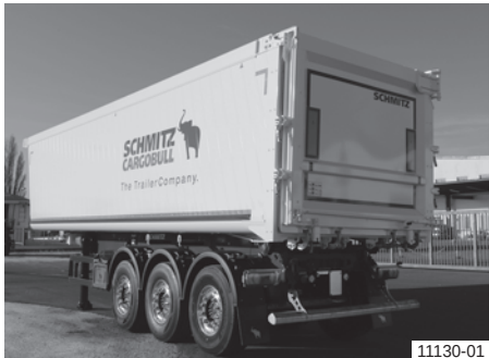
Hliníková skříňová korba s jednokřídlými kombinovanými dveřmi
