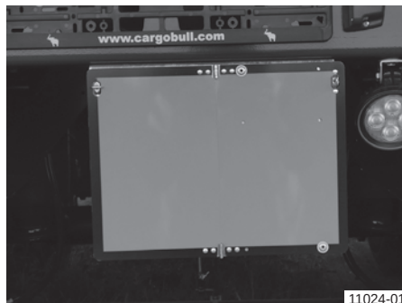
Výstražná tabule nebezpečného nákladu, rozložená a zajištěná
