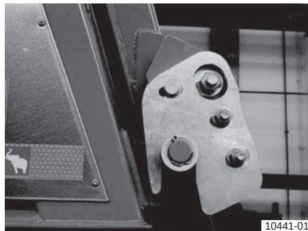
Postranní zajišťovací háky zadní stěny: zajištěné
