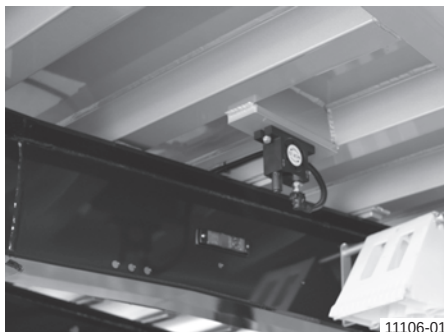
Pneumatický válečkový vibrátor hliníkové skříňové korby
