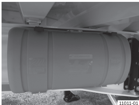
Přepravní box hasicího přístroje na rámu podvozku (jízdní poloha)
