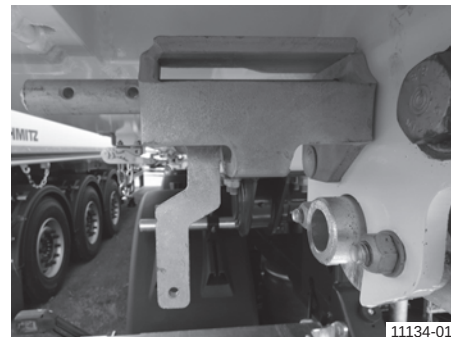
Blokování automatického mechanického zamykání háky, odjištěné
