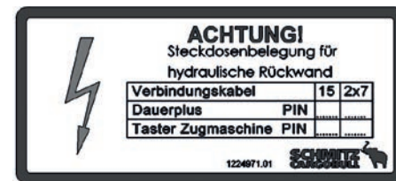
Výstražný štítek „trvalý plus pól a tlačítko hydraulické výklopné zadní stěny“ č. dílu 1224971
