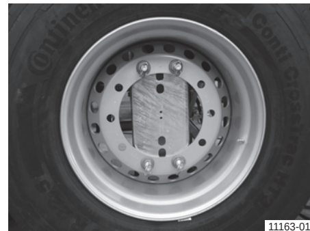
Náhradní kolo v držáku, zobrazení bez ochranného krytu
