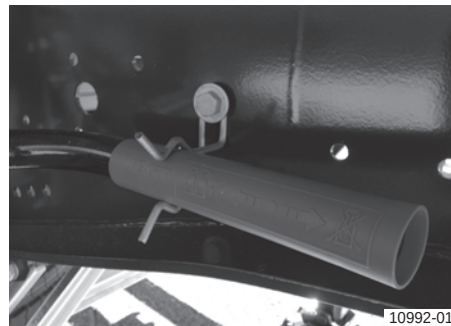
Klika zajištěná v držáku kliky (na rámu)
