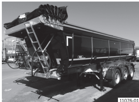
Označení obrysu boční stěny (příklad)
