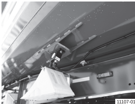
Pneumatický válečkový vibrátor ocelové kulaté korby
