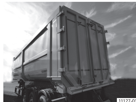
Ocelová kulatá korba s dvoukřídlými dveřmi
