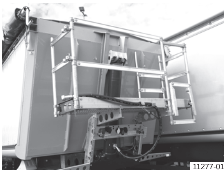
Pracovní plošina (montáž na podvozku)
