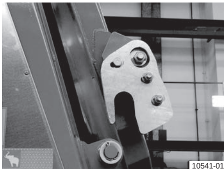
Postranní zajišťovací háky zadní stěny: odjištěné
