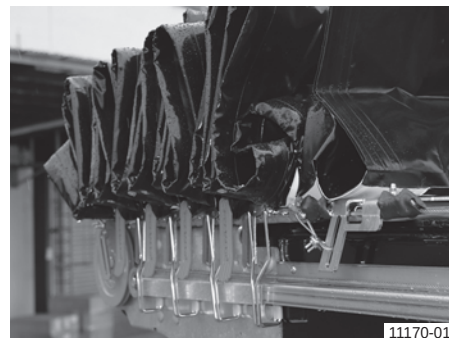
Postranní háky pod vodicí kolejnicí; zobrazení při otevřené posuvné střeše
