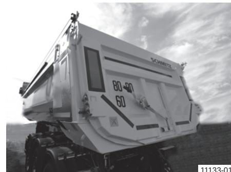
Ocelová kulatá korba s hydraulickou výklopnou zadní stěnou
