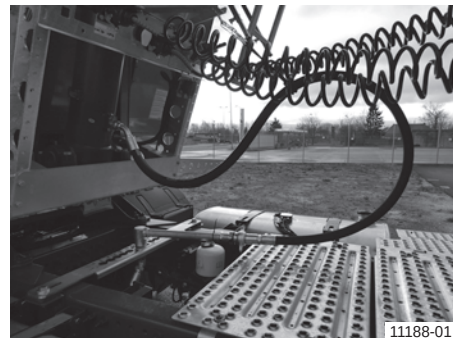
Příklad: Hydraulické připojení k tahači při použití otočného ramena
