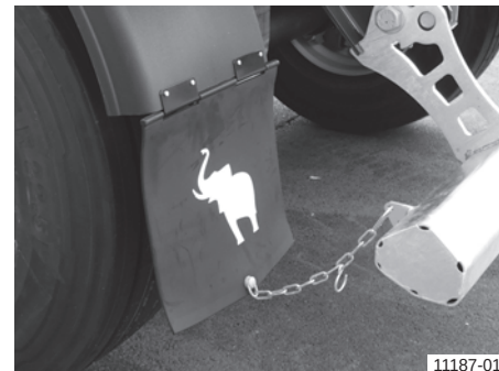
Lapač nečistot sklopný
