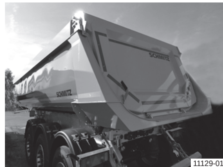
Ocelová kulatá korba s výklopnou stěnou (skloněnou), násypné zařízení
