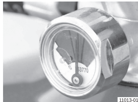
Ukazatel tlaku na hasicím přístroji
