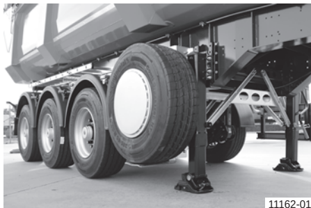
Držák náhradního kola ze strany na podvozku
