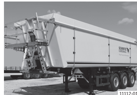
Svinovací plachta, zajištěná upínacími popruhy
