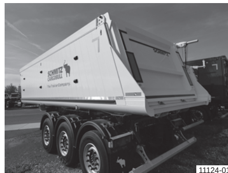
Hliníková skříňová korba s výklopnou stěnou (skloněnou), přiléhající
