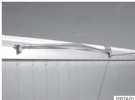
Příčný nosník v parkovací poloze (na obrázku střešovitý příčný nosník)
