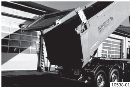
Sklápění se zcela otevřenou zadní stěnou
