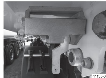
Verrouillage automatique mécanique, bloqué
