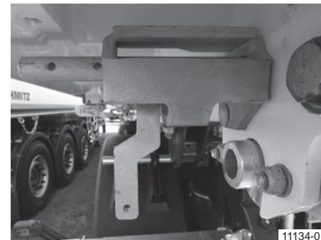
Verrouillage automatique mécanique, débloqué
