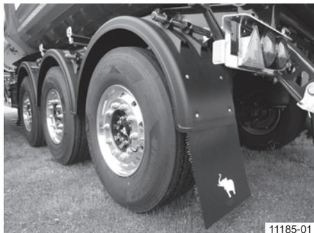
**Recouvrement de roue avec pare-boue sur l'essieu arrière (avec garde-boues)**
