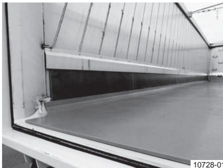
**Variante 1 : Habillage de la benne, env. 300 mm de recouvrement des ridelles latérales et de la ridelle avant**
