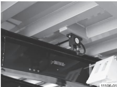
Vibrateur pneumatique à rouleau benne caisse aluminium
