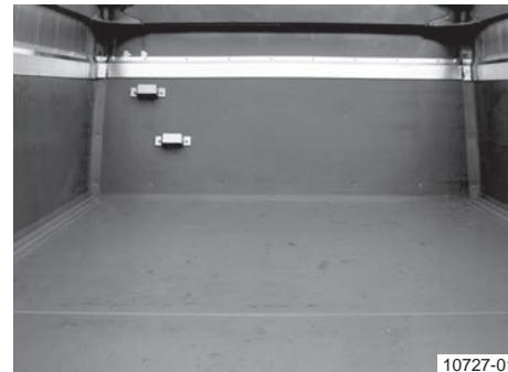
**Variante 2 : Habillage de la benne, env. 900 mm de recouvrement des ridelles latérales et de la ridelle avant**
