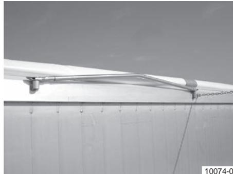
**Arceau transversal en position de stationnement (illustration arceau transversal en forme de toit)**
