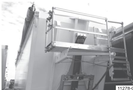
Plate-forme de travail (montage sur la ridelle avant)
