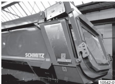
La ridelle arrière est soulevée hors des axes latéraux et légèrement ouverte.
