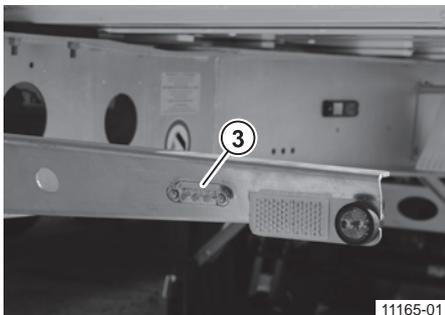
**Témoin de contrôle du système de regonflage des pneus**
