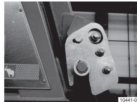
Crochets de verrouillage latéraux de la ridelle arrière : verrouillés
