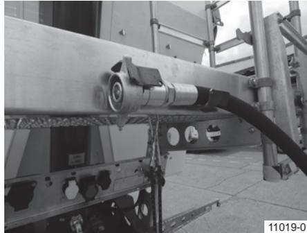
Support flexible hydraulique sur la plate-forme
