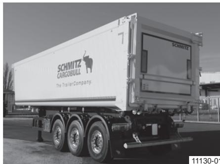
**Benne caisse aluminium avec porte combinée à simple battant**
