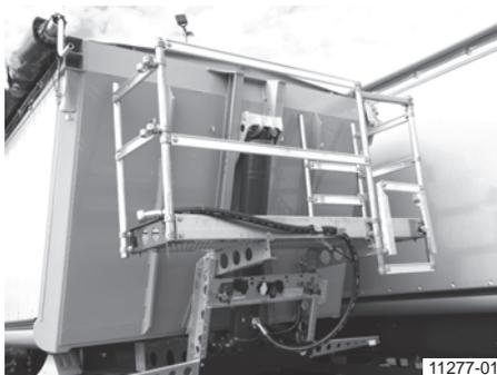
Plate-forme de travail (montage sur le châssis)
