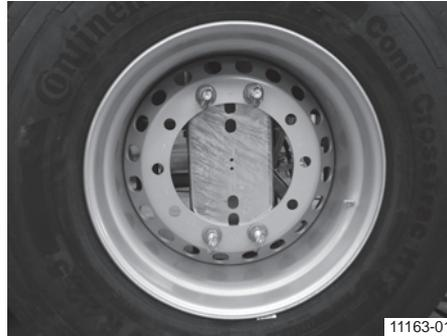
Roue de secours dans le support, illustration sans cache de protection
