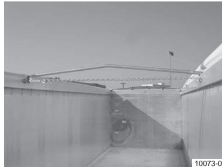
Arceau transversal en forme de toit (en position de conduite)
