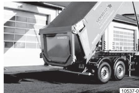
Position d'oscillation avec benne basculée
