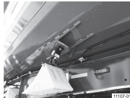
Vibrateur pneumatique à rouleau benne ronde acier
