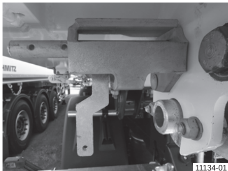
Az automatikus mechanikus kampós reteszelés zára, oldva
