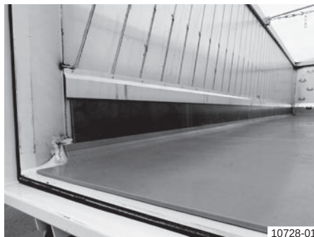
1. változat: Billenőszekrény bélés, az oldal- és a homlokfal kb. 300 mm-es takarása
