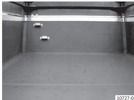
2. változat: Billenőszekrény bélés, az oldal- és a homlokfal kb. 900 mm-es takarása
