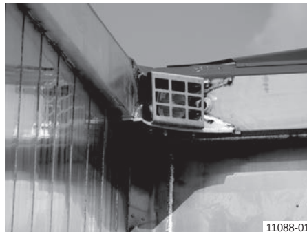
Billenőszekrény belső terének világítása
