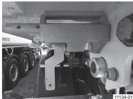
**Blocco del bloccaggio meccanico automatico tramite ganci, abilitato**
