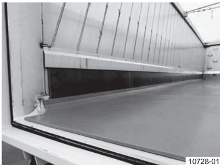
**Variante 1: rivestimento cassone, copertura di ca. 300 mm della sponda laterale e anteriore**
