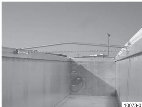
**Centina trasversale a forma di tetto (in posizione di marcia)**
