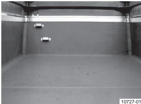
**Variante 2: rivestimento cassone, copertura di ca. 900 mm della sponda laterale e anteriore**
