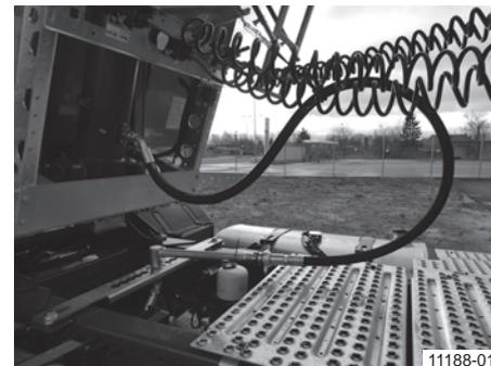
**Esempio: allacciamento idraulico alla motrice utilizzando un braccio orientabile**
