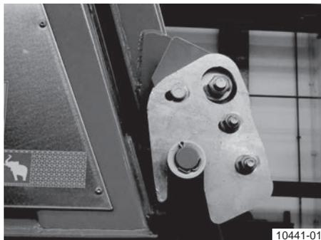
Ganci di bloccaggio laterali della sponda posteriore: bloccati
