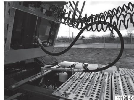
例：スイベルアームを用いての、トラクターとの油圧接続
