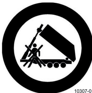
「傾斜ボディ下への立入禁止」警告表示
