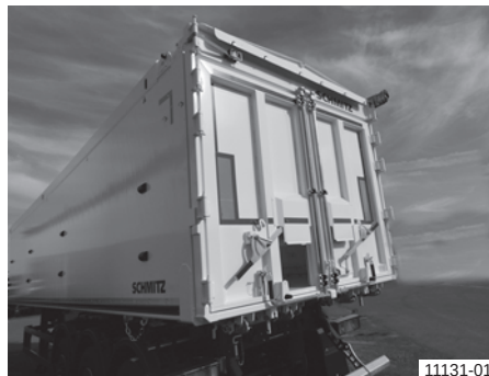
Aliuminis stačiakampis kėbulas su dvivėrėmis kombinuotosiomis durimis su portaliniu skersiniu strypu
