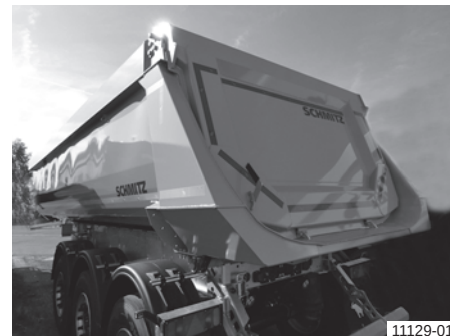
Plieninis pusapvalis lovinis kėbulas su atverčiamuoju bortu (pasviręs), latakų
