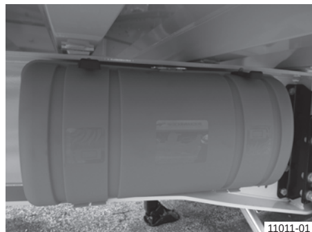
Gesintuvų transportavimo dėžė ant važiuoklės rėmo (važiavimo padėtis)
