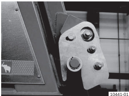
Странична кука за заклучување на задниот сид: заклучена
