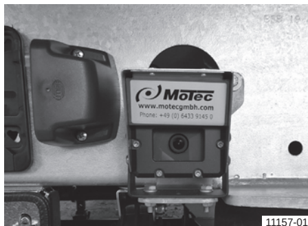
Камера за просторот позади
