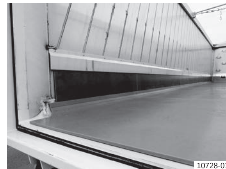
Варијанта 1: Облога на конструкција, приближно 300 mm покриеност на страничните и на предниот сид
