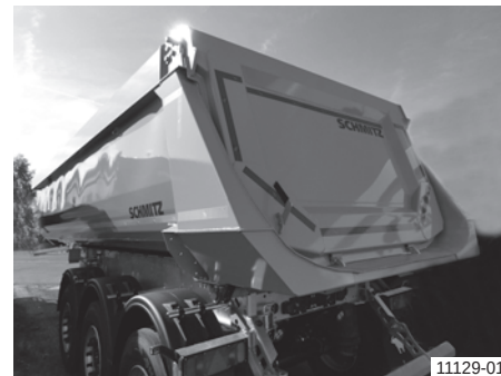
Челична заоблена конструкција со клапна (под агол), внатрешно поставена
