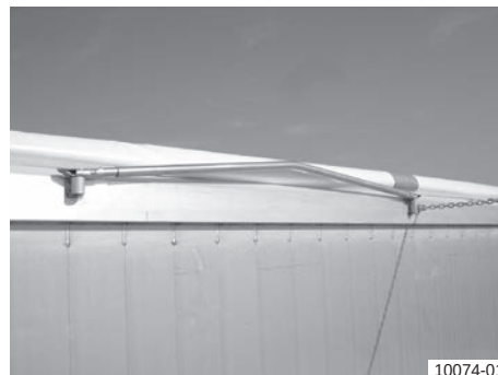
Попречна шипка во позиција на паркирање (илустрација на издигната попречна шипка)
