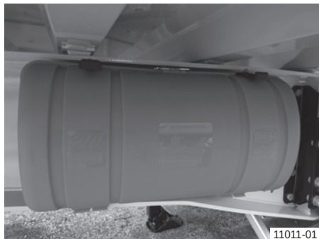
11011-01 Транспортна кутија за противпожарен уред на шасија (позиција за возење)
