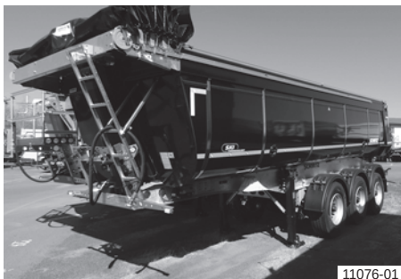
Маркација на контурата на страничните сидови (пример)
