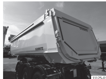
Челична заоблена конструкција со клапна (коса), надворешно поставена
