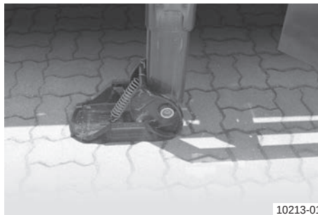
Приспособливо стапало со должинска компензација
