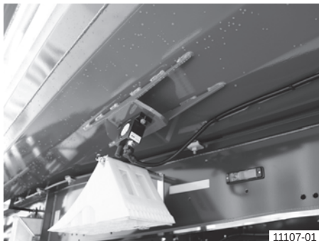
Пневматски вибрирач на челична заоблена конструкција
