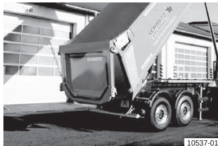
Позиција за клапна при кипирана конструкција
