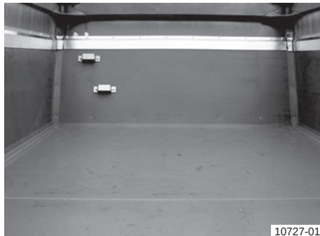
Варијанта 2: Облога на конструкција, приближно 900 mm покриеност на страничните и на предниот сид
