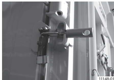
Затворен затегнувач (позиција за возење)
