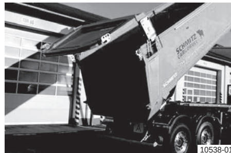
Кипирање со целосно отворен заден сид
