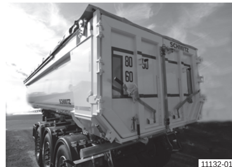
Челична заоблена конструкција со двокрилна комбинирана врата без попречна греда
