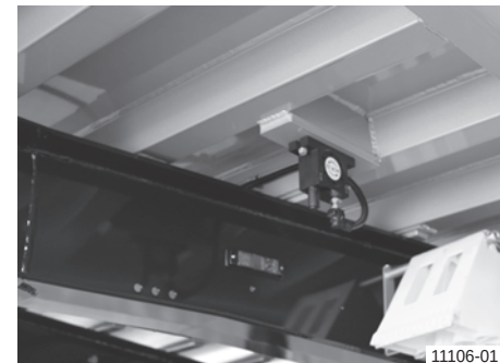
Пневматски вибрирач на алуминиумска товарна конструкција
