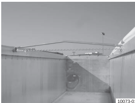
Издигната попречна шипка (во позиција за возење)
