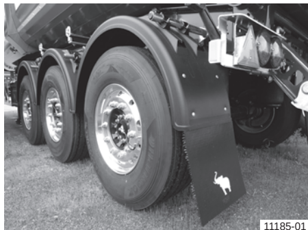
Штитник за тркала со калник на задната оска (со заштита од прскање)
