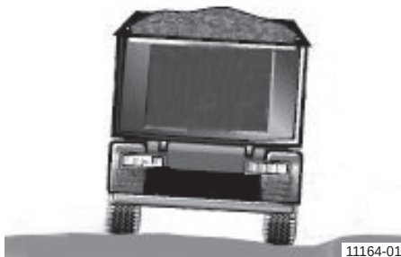
Kipperoplegger met ontoelaatbare zijwaartse helling
