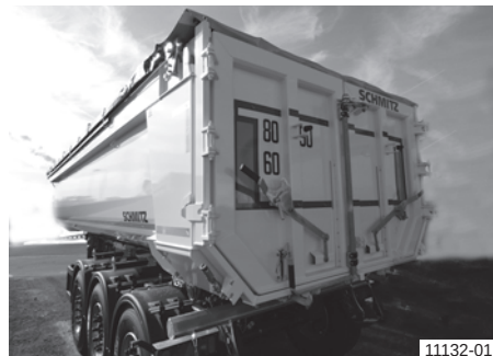
Ronde stalen laadbak met dubbele combideur zonder portaaldwarsbalk
