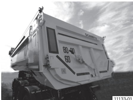
Ronde stalen laadbak met hydraulische achterwandklep
