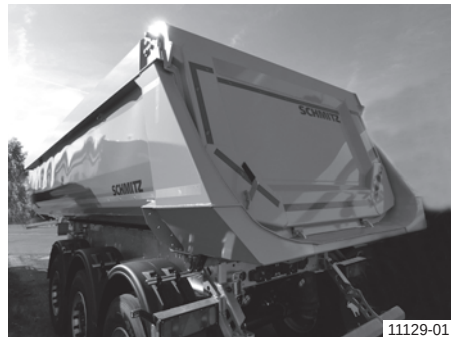
Ronde stalen laadbak met pendelklep (schuin), stortelement
