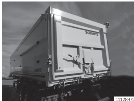
Modulaire aluminium laadbak met pendelklep (recht), opliggend
