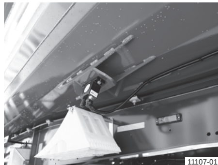
Persluchtrolvibrator ronde stalen laadbak
