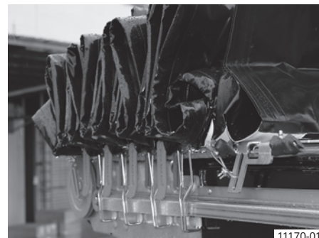
Zijhaken onder de geleiderails; weergave bij geopende schuifafdekking
