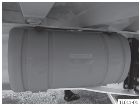
Transportbox brandblusapparaat aan chassis (rijstand)
