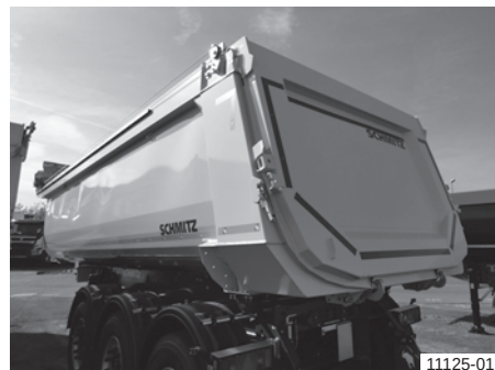
Ronde stalen laadbak met pendelklep (schuin), opliggend
