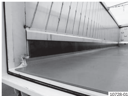
Variant 1: Kiepbakbekleding, circa 300 mm afdekking van de zijwanden en kopwand
