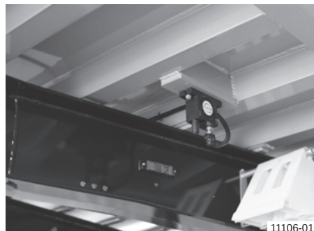
Persluchtrolvibrator modulaire aluminium laadbak
