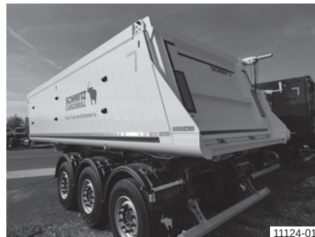
Modulaire aluminium laadbak met pendelklep (schuin), stortelement
