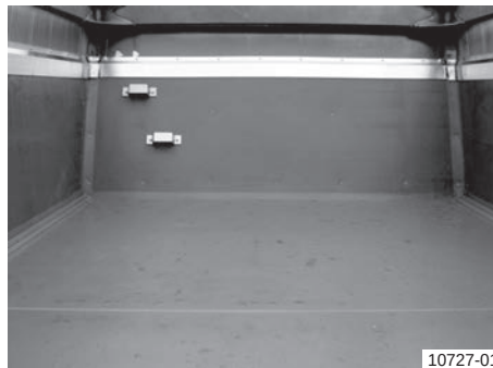
Variant 2: Kiepbakbekleding, circa 900 mm afdekking van de zijwanden en kopwand
