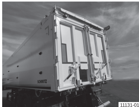
Modulaire aluminium laadbak met dubbele combideur met portaaldwarsbalk
