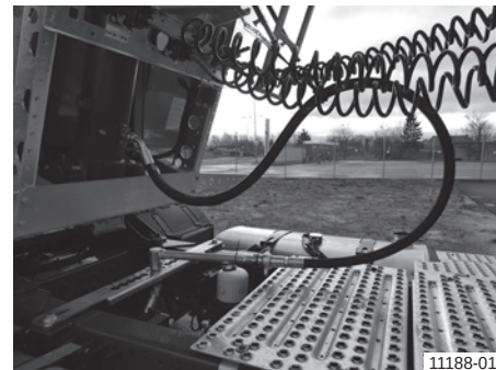
Voorbeeld: Hydraulische aansluiting met trekker bij gebruik van een zwenkarm
