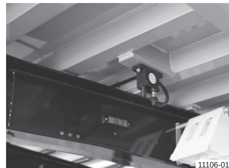
Pneumatyczny wibrator rolkowy prostokątnej skrzyni aluminiowej
