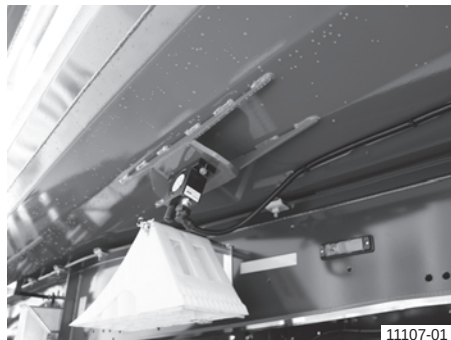
Pneumatyczny wibrator rolkowy zaokrąglonej skrzyni stalowej
