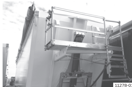
Pomost roboczy (zamontowany na ścianie czołowej)
