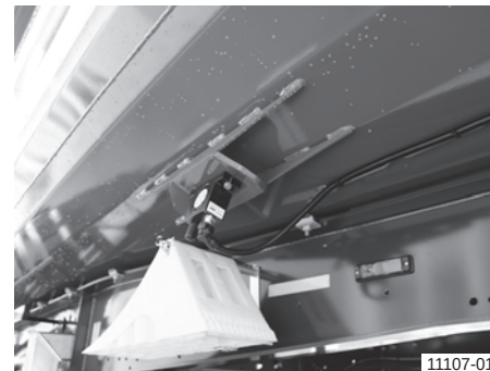
Vibrator rotativ pneumatic cu rolă la bena de oțel rotundă
