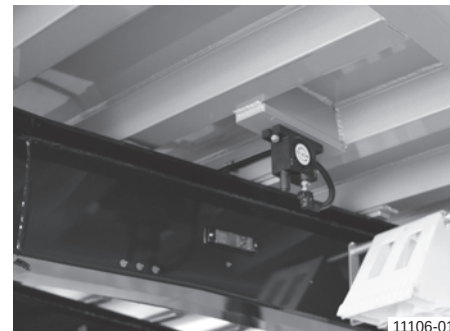
Vibrator rotativ pneumatic cu rolă la bena de aluminiu tip casetă
