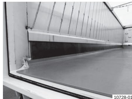
Varianta 1: Înveliș de benă cu acoperire de cca. 300 mm a pereților laterali și frontal
