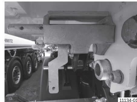
Dispozitiv de blocare a zăvorului cu cârlige mecanic automat, deblocat
