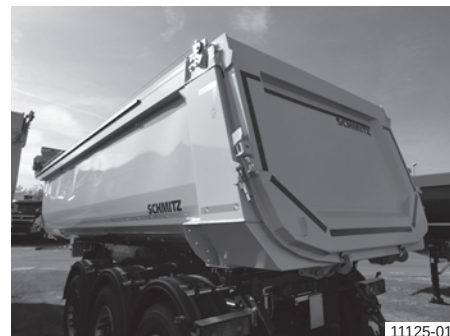
Benă de oțel rotundă cu oblon pendular (înclinat), rezemat
