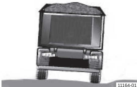
Semiremorcă basculantă cu înclinare laterală inadmisibilă
