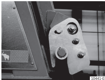
Cârlige laterale de blocare a oblonului din spate: blocate
