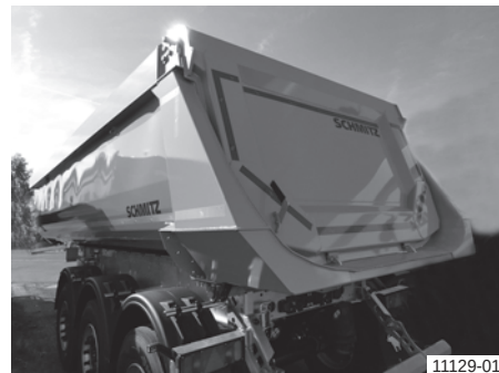
Benă de oțel rotundă cu oblon pendular (înclinat), igheab
