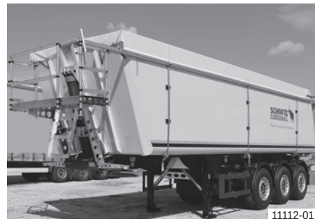
Prelată rulabilă, asigurată cu chingi de tensionare
