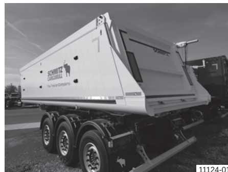
Benă de aluminiu tip casetă cu oblon pendular (înclinat), igheab
