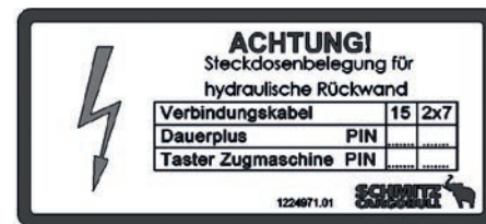
Panou de avertizare „Plus permanent și buton oblon hidraulic din spate”
