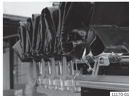
Cârlige laterale sub șina de ghidare; ilustrație cu prelată culisantă deschisă
