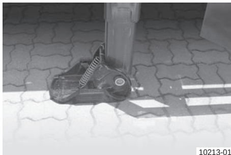
Picior oscilant cu compensator longitudinal
