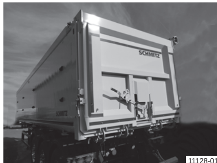
Benă de aluminiu tip casetă cu oblon pendular (vertical), rezemat
