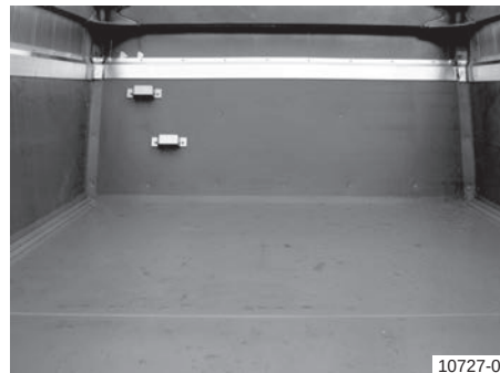
Varianta 2: Înveliș de benă cu acoperire de cca. 900 mm a pereților laterali și frontal
