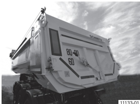
Benă de oțel rotundă cu oblon hidraulic din peretele posterior
