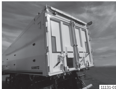
Benă de aluminiu tip casetă cu ușă combinată cu canat dublu cu traversă tip portal
