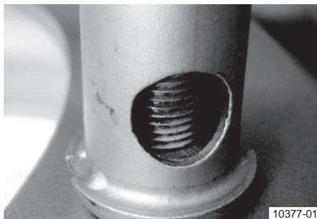
Фрагмент трубчатой гайки с контрольным отверстием
