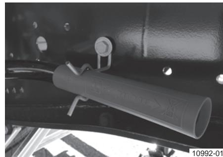
Кривошипная рукоятка, зафиксированная в креплении (на раме)
