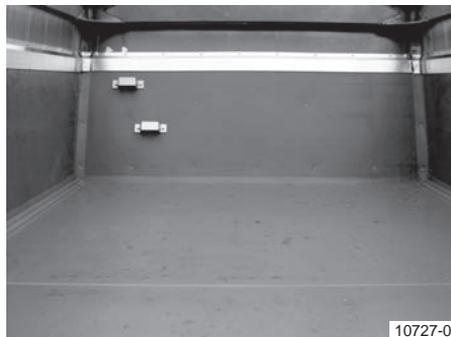
**Вариант 2: Облицовка кузова, ок. 900 мм, покрытие боковой и передней стенок**
