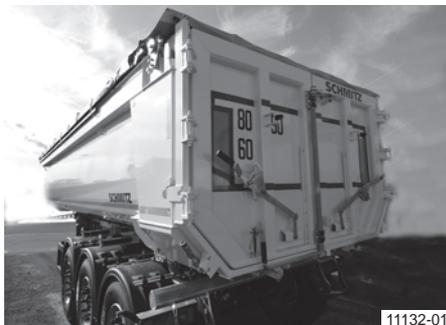
Стальной круглый кузов с двухстворчатой комбинированной дверью без портальной поперечной дуги
