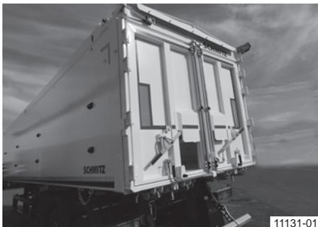
Алюминиевый прямоугольный кузов с двухстворчатой комбинированной дверью с портальной поперечной дугой
