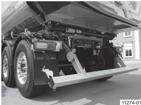
**Противоподкатный брус с электропневматическим приводом (в положении для движения)**
