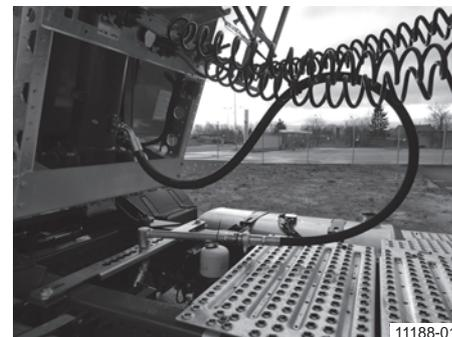
**Пример: Гидравлическое соединение с тягачом при использовании поворотного кронштейна**
