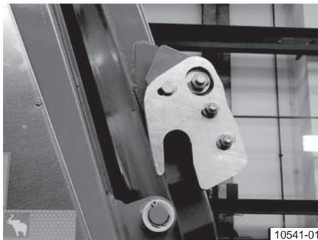
**Боковые фиксирующие крюки задней стенки: разблокированные**
