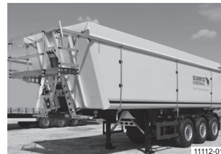
Скатывающийся тент, зафиксированный натяжными ремнями
