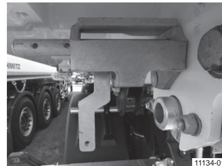
Блокировочное устройство автоматического механического крюкового фиксатора разблокировано
