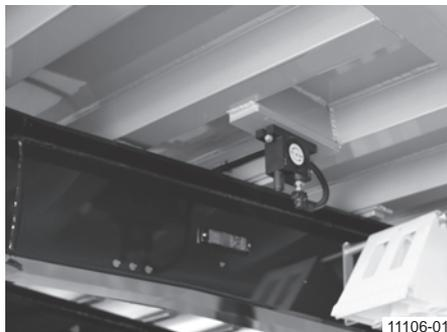
Пневматический роликовый вибратор алюминиевого прямоугольного кузова
