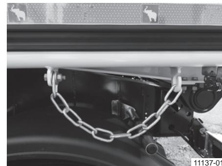
Предохранительная цепь в положении для движения
