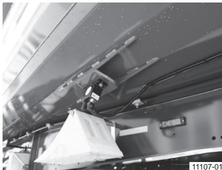
Пневматический роликовый вибратор стального круглого кузова
