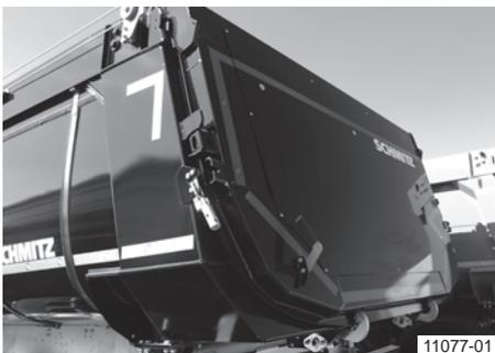
**Маркировка контура на задней стенке (пример)**
