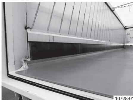
**Вариант 1: Облицовка кузова, ок. 300 мм, покрытие боковой и передней стенок**
