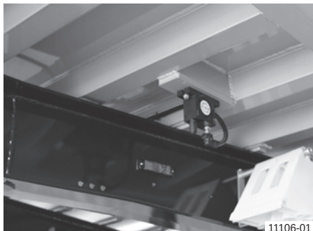
Ekscentrični vibrator na stisnjen zrak na aluminijastem škatlastem koritu
