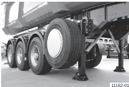
Držalo rezervnega kolesa ob strani na podvozju
