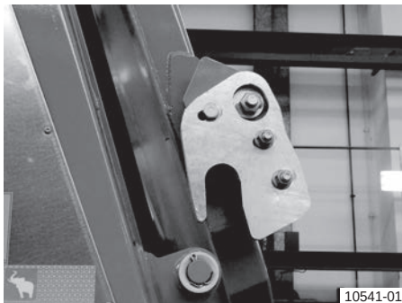
Stranski kavljji zapaha na zadnji steni: sproščeni
