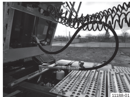
Primer: Hidravlični priključek vlečnega vozila pri uporabi vrtljive roke
