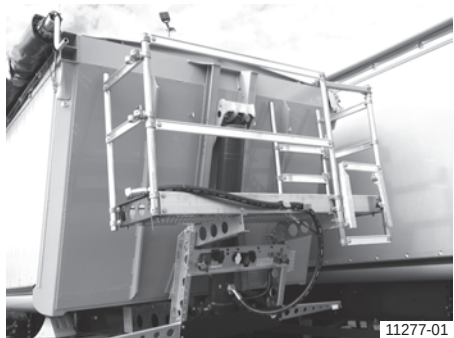
Delovni oder (montaža na podvozju)
