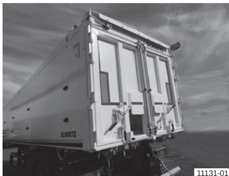
Aluminijasto škatlasto korito z dvokrilnimi kombiniranimi vrati s portalnim prečnikom
