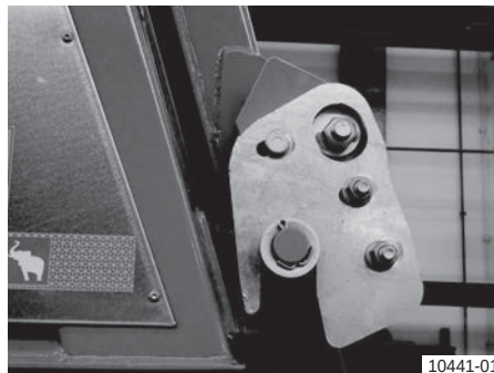
Stranski kavliji zapaha na zadnji steni: zapahnjeni
