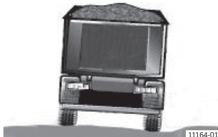
Prekucni polpriklonnik z nedovoljenim bočnim nagibom
