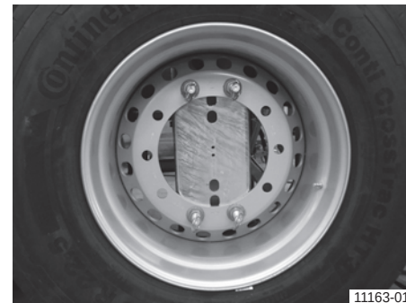
Rezervno kolo v držalu, prikaz brez zaščitnega pokrova
