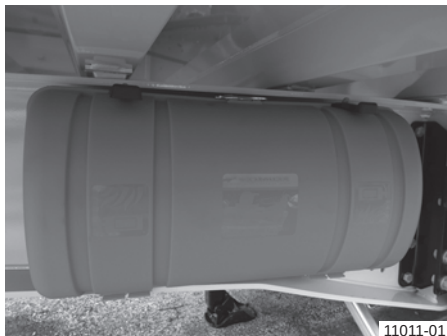
Transportni zaboj za gasilnik na ogrodju podvozja (položaj za vožnjo)
