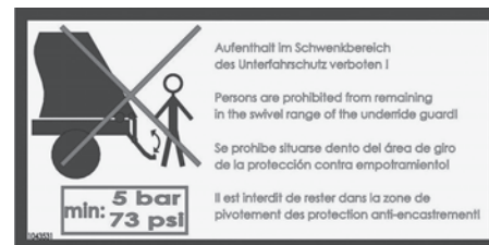
Opozorilni znak »Pnevmatska naletna zaščita«
