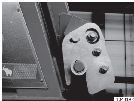
Stranski kavlji zapaha na zadnji steni: zapahnjeni
