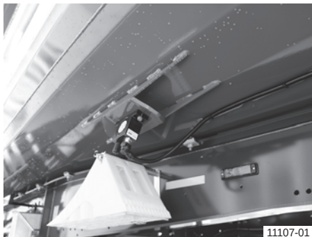
Ekscentrični vibrator na stisnjen zrak na jeklenem okroglem koritu
