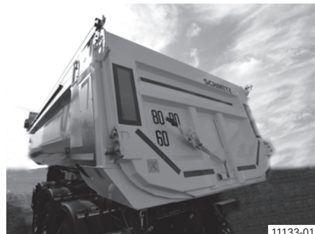
Okroglo jekleno korito s hidravlično loputo v zadnji steni
