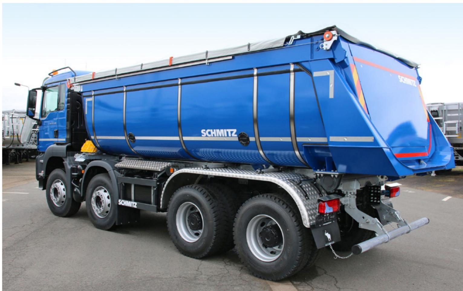
El aislamiento térmico del M.KI representa únicamente un aumento del peso de 195 kilogramos.
