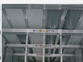
Le système de ventilation dans la S.KO COOL SMART permet une utilisation totalement flexible des barres d'arrimage.
