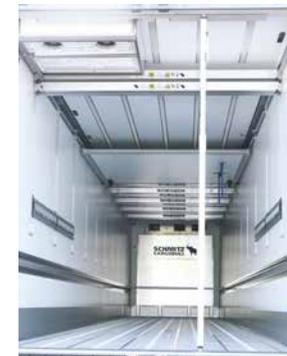
Senkrechte Teleskopbalken für den Multifunktionsboden zur Ladungssicherung.
