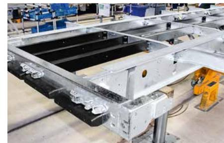
Die zusätzlichen Längsträger am Heck sorgen für eine höhere Staplerachslast.
