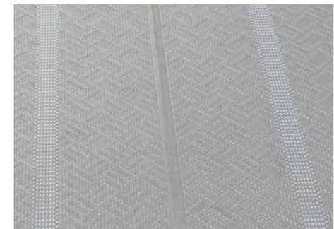
Profile im Boden erlauben die kraftschlüssige senkrechte Ladungssicherung und sind extrem einfach zu reinigen.
