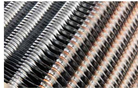
Energieersparnis durch bis zu 50 % weniger Abtauzyklen. Die Kühlrippen sind versetzt angeordnet. Das verlangsamt den Vereisungsprozess, spart Kraftstoff und sichert die Kühlkette.
