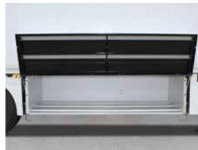
Palettenkasten für 36 Paletten – in der Ausführung für die aerodynamische Seitenverkleidung.\*
