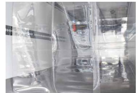
Der längsverschiebbare Streifenvorhang minimiert den Kälteverlust am Heckportal.
