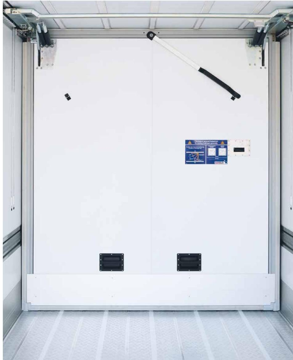
Mobile Trennwände sorgen für die klimatische Trennung von mehreren Temperaturzonen. Sie können für eine flexible Einteilung längs im Trailer verschoben werden.
