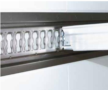
Die flächenbündig eingelassene Ladungssicherungsschiene V7 erlaubt die freie Positionierung der Ladungssicherungsbalken auf ganzer Länge.
