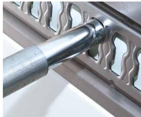
In das besondere Profil der Ladungssicherungsschiene V7 lassen sich auch senkrechte Teleskopbalken als waagerechte Balken sichern.
