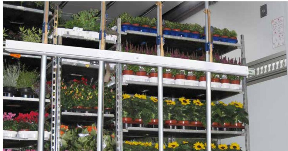
Für den Blumentransport die ideale Ladebreite: Der S.KO COOL bietet entscheidende Zentimeter im Innenraum und eine ausgefeilte Ladungssicherung von Rollwagen.
