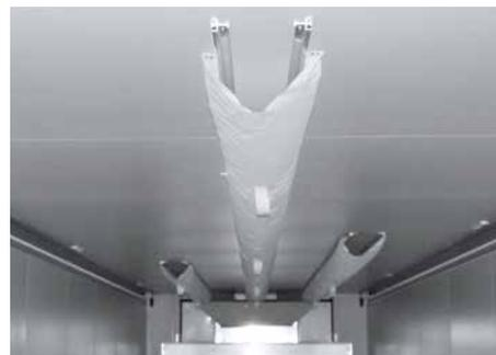
Gleichmäßig kühl: Flexible Kühlkanäle für die Verteilung der Kaltluft auf Deckenhöhe.
