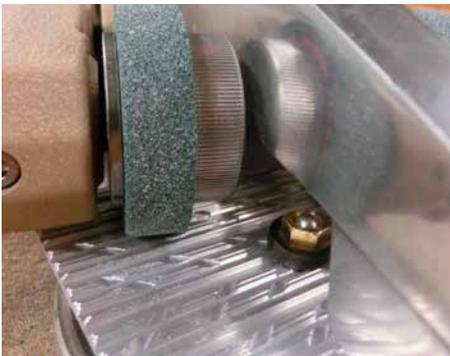
Der Taber-Test prüft mit einer rotierenden, abrasiven Walze die Abriebbeständigkeit.
