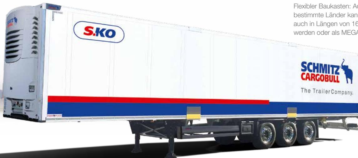
Flexibler Baukasten: Auf Kundenwunsch und für bestimmte Länder kann der S.KO COOL SMART auch in Längen von 16,5 und 17,8 m geliefert werden oder als MEGA mit 3 m Innenhöhe.\*
