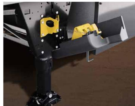
Stützwindwerk mit Ferry Lashing und Staufach für den Sicherungskeil.
