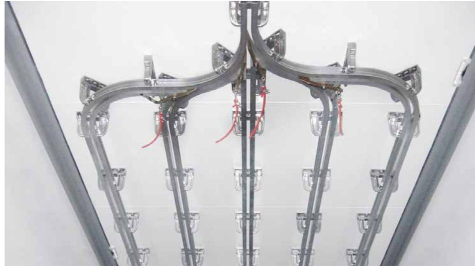
Sonderausführung auf Anfrage: Fleischhangsystem als Bi-Rail-System für den Einsatz im westeuropäischen Wirtschaftsraum. Dach und Seitenwände des FERROPLAST® Koffers sind speziell verstärkt und können auf der ganzen Dachfläche bis zu 24 t bei gleichmäßiger Ladung tragen.
