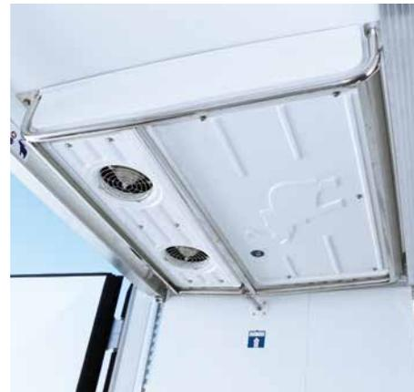
Kompakter, leistungsfähiger Deckenzusatzverdampfer für den Zweikammerbetrieb mit verchromten Schutzkäfig gegen äußere Beschädigungen beim Laden.
