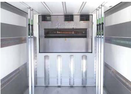
Luftzirkulationsprofile aus Aluminium an der Stirnwand verhindern das Abschneiden der Luftzuführung zum Kühlgerät beim Laden.
