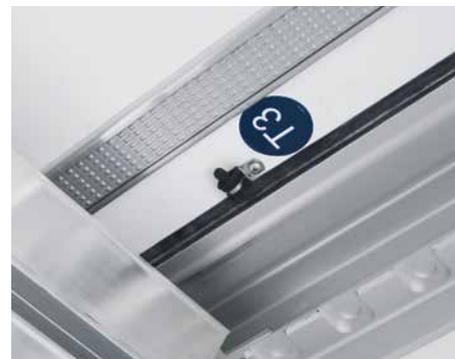
Bis zu vier zertifizierte Temperatursensoren überwachen den Innenraum. Sie werden für jedes Fahrzeug einzeln kalibriert.
