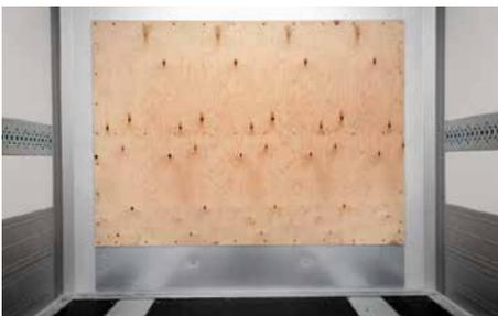
Verstärkte Stirnwand mit Holzplatte und hochgezogener Stahl-Kante.
