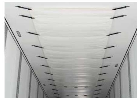
Für eine gleichmäßige Verteilung der Kühlluft sorgt die locker gespannte Kälteplane unter dem Dach.\*
