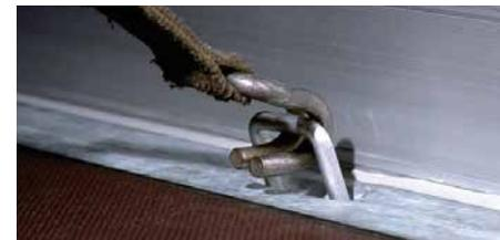
Zusätzliche Ladungssicherung im Frachtraum: Zurrösen zum Niederzurren von Stückgut.
