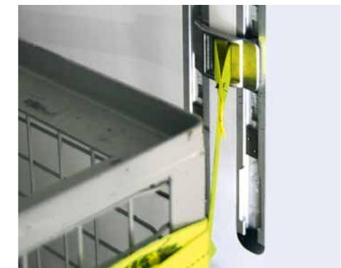
Spezielle Zurrgurte lassen sich in die Doppelstock-Schienen einsetzen.
