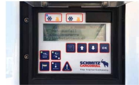
Das Kontrollpanel am Kühlgerät ermöglicht die Konfiguration aller für den Transport wichtigen Stellgrößen und das Auslesen des aktuellen Status in 17 europäischen Sprachen. Mit PIN-Verschlüsselung gegen unbefugten Eingriff.
