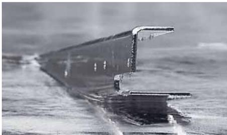
Qualität am Stück: Erst das fertig bearbeitete Werkstück wird in das Zinkbad getaucht. Durch dieses Stückverzinken sind Schnittkanten und Hohlräume genauso geschützt wie die großen Außenflächen.
