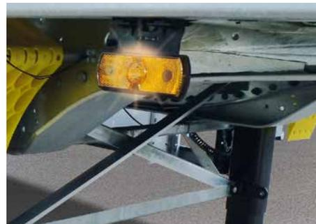
Als zusätzlicher Schutz für Radfahrer und Fußgänger ist die Seitenmarkierungsleuchte mit Blinkfunktion verfügbar.
