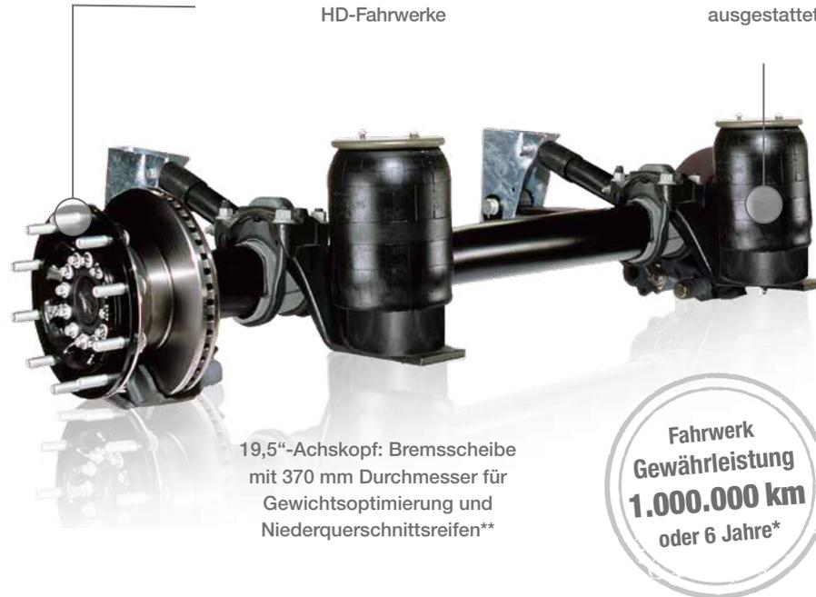
19,5“-Achskopf: Bremsscheibe mit 370 mm Durchmesser für Gewichtsoptimierung und Niederquerschnittsreifen\*\*
