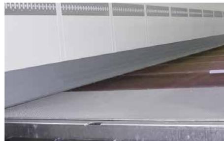
Für eine erhöhte Lebensdauer vermindert ein zusätzliches Bodenblech am Heckportal den Verschleiß beim Laden.\*
