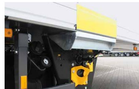
Der Kofferaufbau ist durch Edelstahl-Scheuerbleche über den Greiferkanten geschützt.
