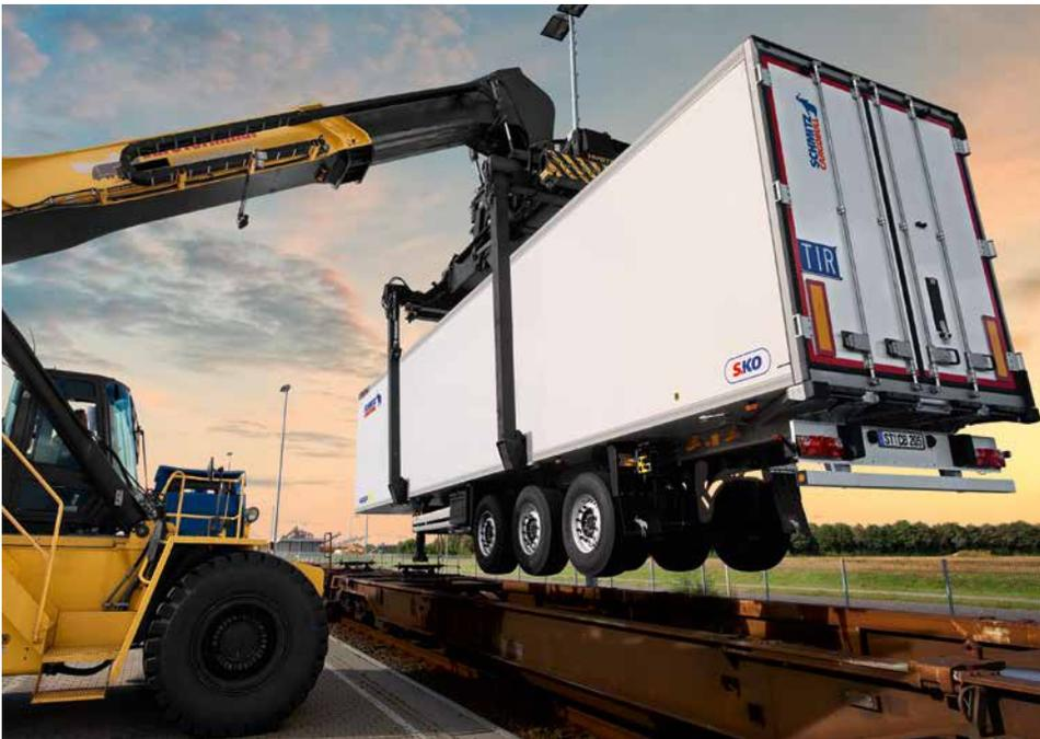
Bahntransport von abgesetzten Einheiten: Dank robuster Greiferkanten und verstärkten Edelstahl-Scheuerblechen ist eine risikofreie Verladung im Schienenverkehr möglich. Das ROTOS-Fahrwerk schützen spezielle Splitter vor Schäden an der Luftfederung. Mehr dazu in der ROTOS-Broschüre.
