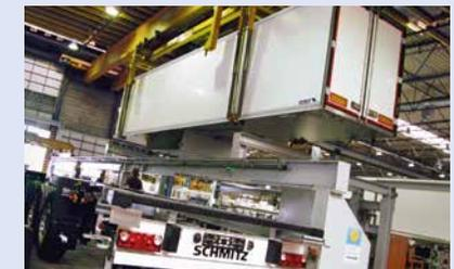
Der selbsttragende FERROPLAST® Kofferaufbau wird als Einheit auf das komplette Kurzchassis aufgesetzt und montiert.
