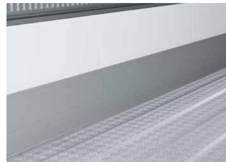
Die Scheuerleiste ist mit der Bodenwanne verschweißt. Bündig in die Wand eingelassen behalten Sie die volle Ladebreite von 2.460 mm.
