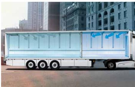
Mit zwei unterschiedlichen Temperaturzonen sicher und effizient unterwegs. Zum Beispiel im Tiefkühlbereich von -20 °C und bei einem Plusgrad von 10 °C exakt temperiert.
