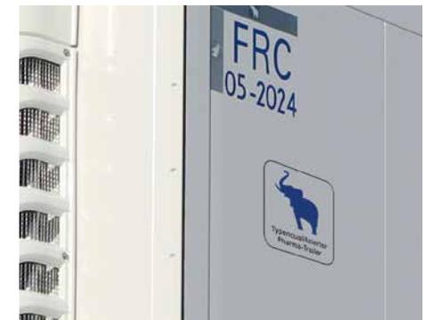
Zertifikat für Pharmatransporte plus TrailerConnect® Telematik für die Überwachung der Kühlkette in Echtzeit.
