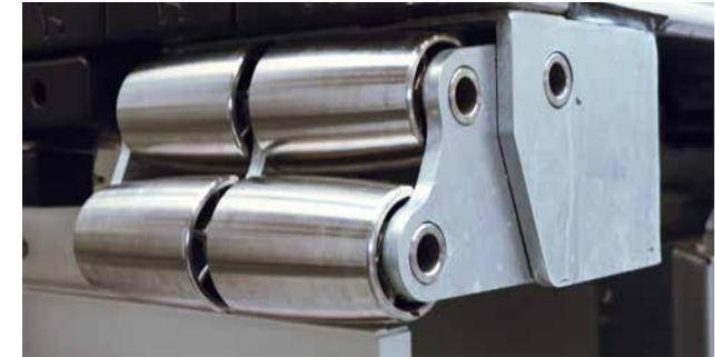
Hart im Nehmen: Das Dynamic Ramp Protection-System (DRP-System) absorbiert hohe Energiemengen mit einer doppelten Dämpfereinheit.
