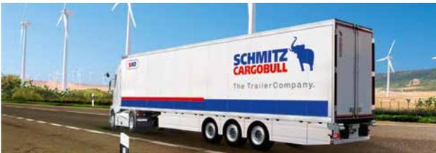
Die Vollverkleidung spart bis zu 4 % Kraftstoff durch die Verringerung des Luftwiderstands am gesamten Lastzug. Der modulare Aufbau erleichtert die Wartung und senkt die Reparaturkosten.\*
