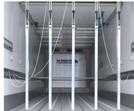
Für die senkrechte Ladungssicherung gibt es Teleskopbalken mit speziellem Fuß für den Multifunktionsboden.
