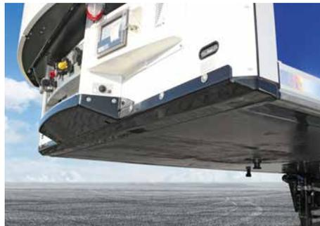
Besserer Aufsattelschutz – auch beim seitlichen Anfahren – durch vollflächige Sattelplatte mit Kantenschutz.
