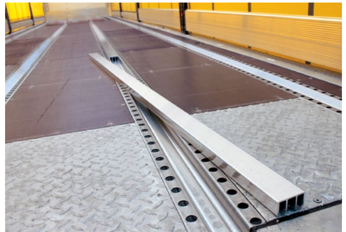
Joloda-Schienen mit Lochraster und stabilen Aluminium-Abdeckungen sind einfach zu reinigen und erleichtern das Handling und Sichern der Ladung.
