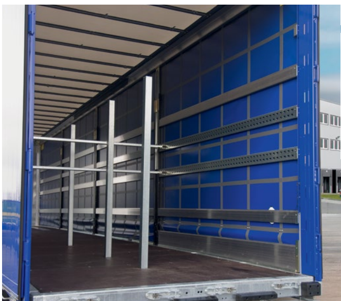
Für den Transport von Profilen und Stangenmaterial: Zusätzliche Rungen und Stahl-Aufsatzlatten mit waagerechten Balken.
