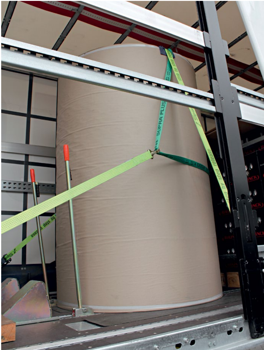
Papierrollen-Transport mit Sicherung durch Form- und Kraftschluss. Die Kopflasche der stehenden Rolle sichert auch gegen Kippen.
