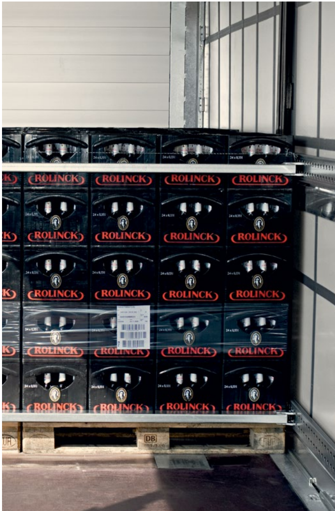
Querballen vor und hinter der Fracht sichern Teilladungen gegen Verrutschen in Längsrichtung.
