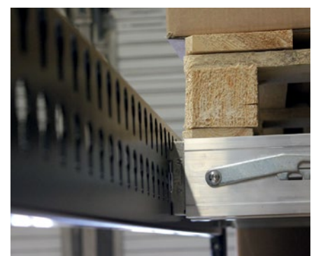
Kantenanschlag der Stahllatte für die Palette
