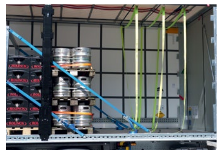
Bei Nichtgebrauch oder Beladung werden die Ladungssicherungsgurte einfach verschoben, bzw. durch die Retainer unter das Dach gezogen, so bleibt der Laderaum frei. So können diese auf jede beliebige Position im Laderaum verschoben werden.
