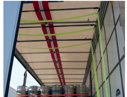
Das zwischen den Dachholmen angebrachte Sliding Lashing-System ermöglicht eine individuelle Ladungssicherung. Verschiebbare Retainer nehmen Ladungssicherungsgurte auf. So können diese auf jede beliebige Position im Laderaum verschoben werden.
