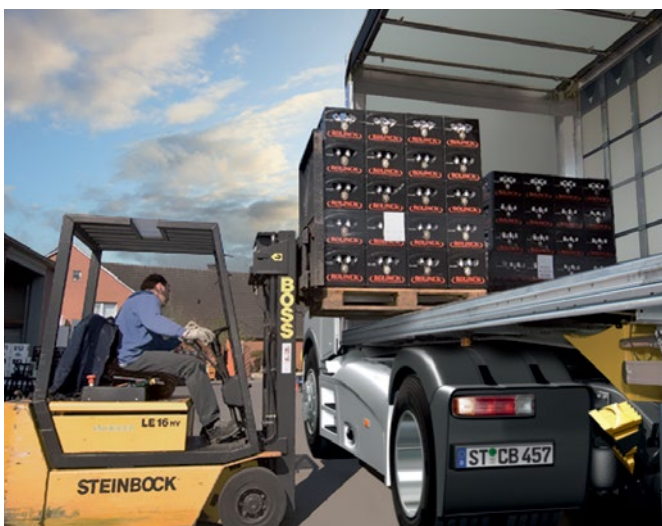
Querballen vor und hinter der Fracht sichern Teilladungen gegen Verrutschen in Längsrichtung.
