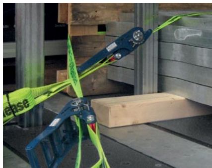
Formschlüssig zur Seite und nach vorne gesichert und niedergezurrt.
