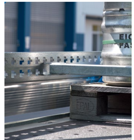
Waagrecht eingesetzte Aufsatzlatten stellen den seitlichen Formschluss bei palettierten Oktabins her. Sperrbalken sichern in Längsrichtung.
