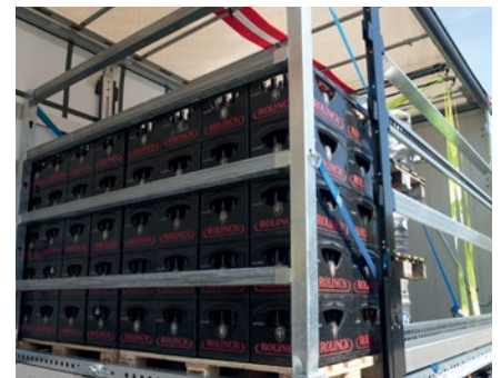
Nach vorn formschlüssig gesicherte Ladung mit Sicherungsbalken und Stützen, die mit diagonal gespannten Gurten gesichert werden.
