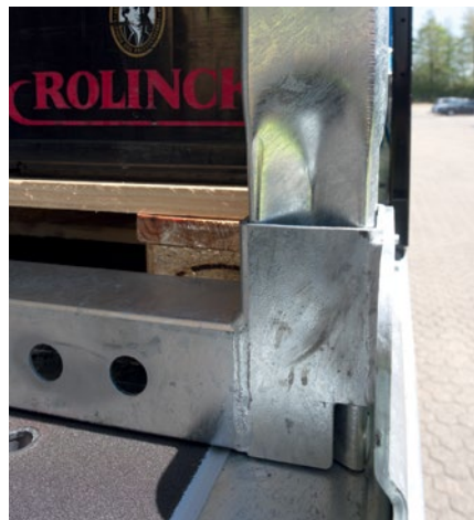
Beispiele für den Einsatz von Vertikalstützen zur Ladungssicherung bei Paletten und Stückgut.
