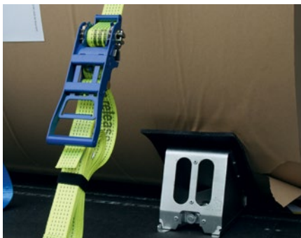
Keile sichern formschlüssig eine Papierrolle, Zurrgurte erhöhen den Anpressdruck.
