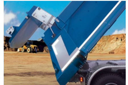
Hydraulische Rückwand Als aufliegende Rückwandklappe ideal für grobe Schüttgüter.
