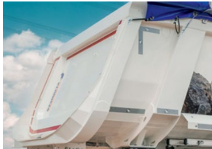
Innenliegende Pendelklappe mit Schütte. Als Variante ist auch eine aufliegende Pendelklappe mit umlaufender Dichtung verfügbar.
