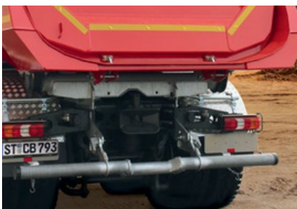
Optional lieferbar Gekröpfter, klappbarer Unterfahrschutz für Fahrzeuge mit Anhängerkupplung.
