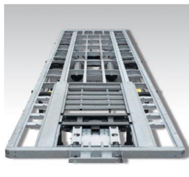
**Rolliertes MODULOS-Chassis:** Korrosionsbeständig und reparaturfreundlich dank der gebolzten und feuerverzinkten Technologie.
