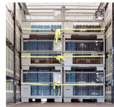
**Rückwärtige Ladungssicherung** mit aufgenähten Planen-Schlaufen für Spanngurte oder Sicherungsplanen. In drei Reihen übereinander haben die Schlaufen eine Sicherungskraft von bis zu 7.500 daN bei Teilladung (pro Reihe 2.500 daN).
