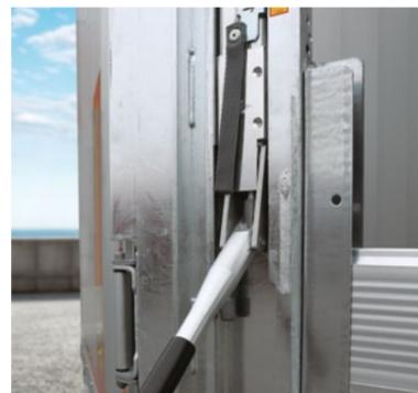
**Manuelles, in die Eckrungen integriertes Liftsystem**, flexibel und zuverlässig, mit eingebauter Höhenverstellung.
