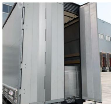
**Geteiltes Portal an Stirnwand:** Das vierflügelige Portal ermöglicht das Öffnen auch bei engem Raum zwischen Motorwagen und Anhänger.
