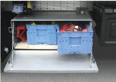
Stahl-Box am Fahrgestell zum Verstauen von Ladungssicherungsmitteln.
