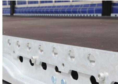
Durchgehende Zurrlochung im Außenrahmen für eine flexible Ladungssicherung. Optional mit Palettenanschlagleisten.
