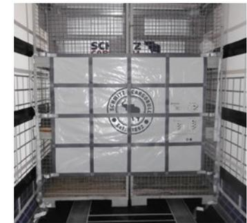
Rückwärtige Ladungssicherung bei Teilladungen mit aufgenähten Planen-Schlaufen z. B. für Spanngurte oder Sicherungsplanen. In drei Reihen übereinander haben die Schlaufen eine Sicherungskraft von bis zu 7.500 daN bei Teilladung (pro Reihe 2.500 daN).
