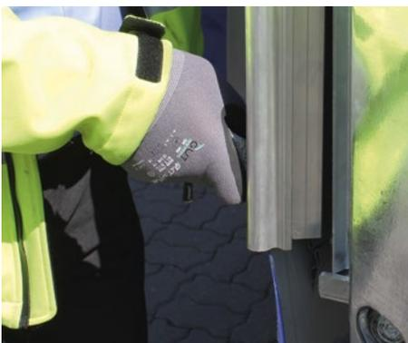
Eine Hakleiste an der Stirnwand erlaubt eine höhere Spannkraft der Plane – nur in Verbindung mit integrierten Planen-Schlaufen.
