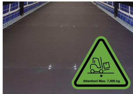
Geklebter Boden: Höhere Staplerachslast von 7,5 t, versiegelte Ladefläche gegen Feuchtigkeit.
