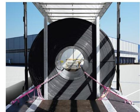
Schwere Coils richtig transportieren: Die kombinierte Ladungssicherung von schweren Bandstahl-Rollen.
