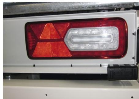
LED-Heckleuchte mit markanter Blinkfunktion, energiesparend und ausfallsicher. (Option)
