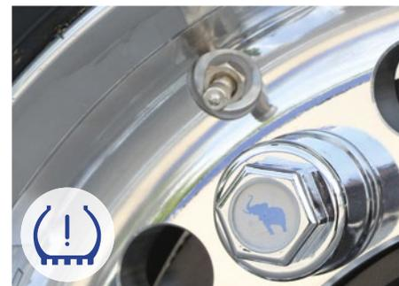
Reifendruck-Kontrollsystem: Vermindert Verschleiß der Reifen, senkt die Kraftstoffkosten und reduziert die Gefahr einer Panne. Der Sensor ist im Reifen direkt auf der Felge montiert.
