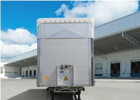
Stahl-Eckungen an Stirnwand und Heckportal erhöhen die Aufbaufestigkeit.
