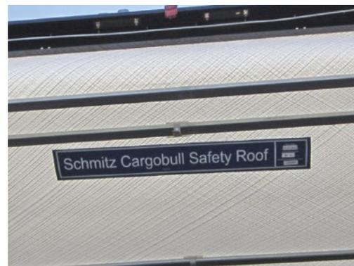
Das Schmitz Cargobull Safety Roof – verstärkt durch integrierte Kunststoff-Fasern – erhöht die Aufbaufestigkeit.
