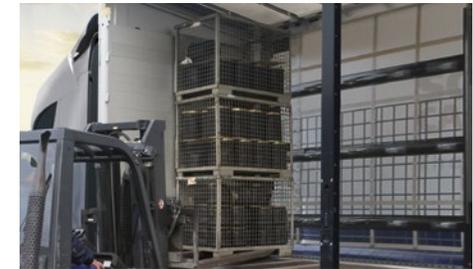
Volumen bis 100 m<sup>3</sup> für die Automotive-Logistik: Gitterboxen bis 3 m Innenhöhe formschlüssig laden.
