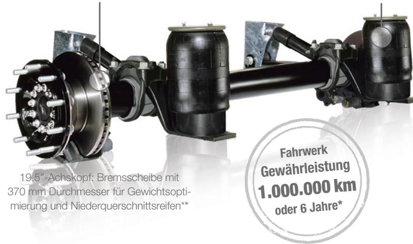
19,5"-Achskopf: Bremsscheibe mit 370 mm Durchmesser für Gewichtsoptimierung und Niederquerschnittsreifen\*\*
