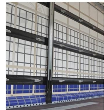
POWER CURTAIN: Aufbau ohne Aufsatzlatten und Lattentaschen für verkürzte Be- und Entladezeiten.
