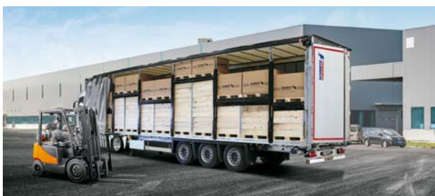
Mit flexiblen Ausstattungsmöglichkeiten sind Curtainsider, die seitlich be- und entladen werden können, echte Allrounder.
