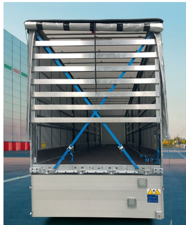
Aufbaufestigkeit nach CODE XL durch diagonales Spannkreuz und eingelegte Aluminiumlatten.
