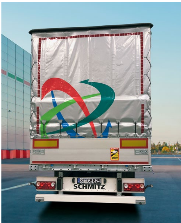
Vorbereitet für den Transport überlanger Fracht: Sattelcurtainsider S.CS mit Bordwand am Heck und Rollplane.
