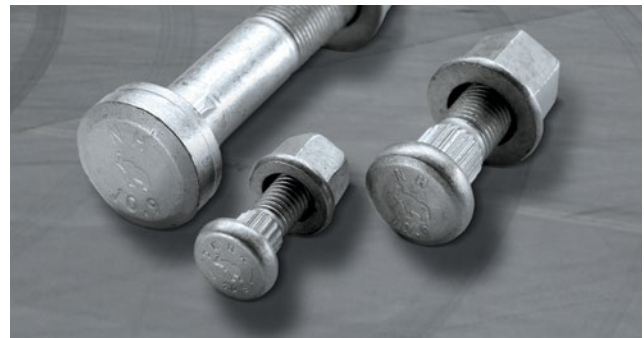
Die hochfesten Rändelbolzen von Schmitz Cargobull besitzen Längsrillen am Schaft und verkeilen sich damit in der Bohrung. Die Verbindung ist dadurch auch gegen Verdrehen gesichert.
