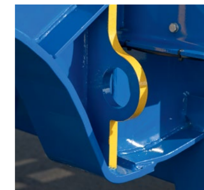
Für den Einsatz im Fahrverkehr ist das Sattelcontainer-Fahrgestell serienmäßig mit Ferry Lashings ausgestattet.
