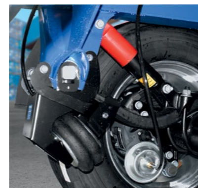
Die Liftachse ® als Anfahrhilfe verlängert den Radstand und verstärkt damit den Druck auf die Antriebsachse.
