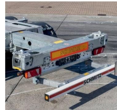
Der **Heckausschub** fährt **pneumatisch** auf die gewählte Containerposition aus. Für 45' Container – **herausziehbarer Unterfahrerschutz**.
