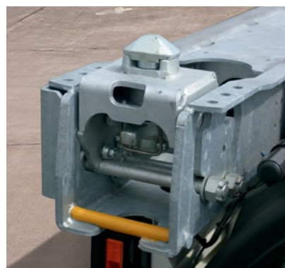
Zwei STEP LOCKs ® am Heckausschub passen Ihr Sattelcontainer-Chassis mit zwei Handgriffen an.
