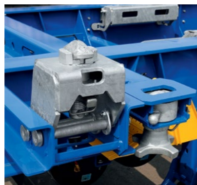
Bei 2 x 20' Beladungen übernehmen zwei KLAPP LOCKs die hintere Verriegelung des vorderen Containers.
