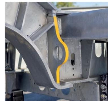
Für den Einsatz im Fährverkehr ist das Sattelcontainer-Fahrgestell mit **Ferry Lashings** ausgestattet.
