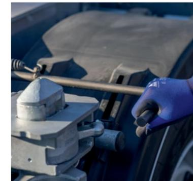
**Manuelle Verriegelung** für den pneumatischen Heckausschub.
