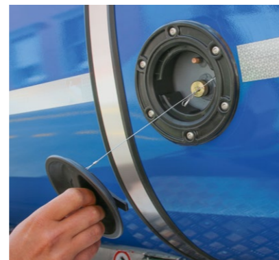
Zukunftssicher: Optionale Messöffnungen für manuelle, direkte Temperaturmessung und Vorbereitung für den Einbau einer elektronischen Messtechnik.
