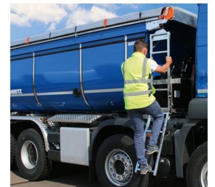
Seitliche Aufstiegsleiter für die Ladungskontrolle.
