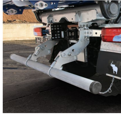
Klappbarer Unterfahrerschutz für den Einsatz am Straßenfertiger.
