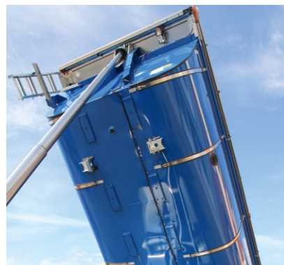
Wartungsfreundliche Segmentbauweise: Einzelne Segmente können schnell ausgetauscht werden.
