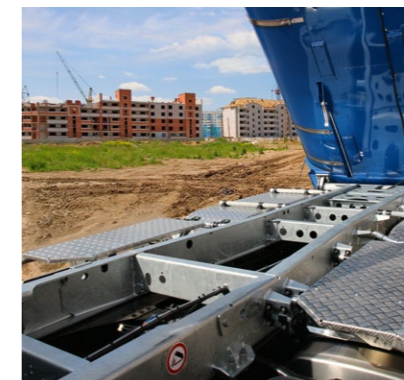
Der extrem torsionssteife Hilfsrahmen macht Fahrzeug und Aufbau zur hoch belastbaren, sicheren und effizienten Einheit.
