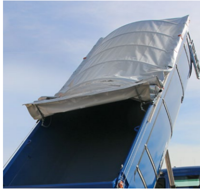
Elektrisches Schiebeverdeck: temperaturbeständig, sowie leicht und schnell vom Boden aus bedienbar.
