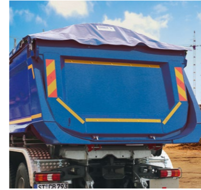
Innenliegende Pendelklappe mit Schütte für zentriertes Entladen.
