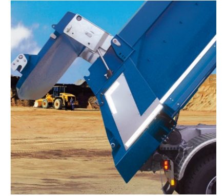
Hydraulische Rückwand: Ideal für abrasive, grobe Schüttgüter und kontrolliertes Entladen.
