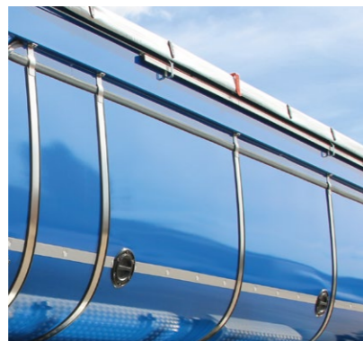
Schwimmend verlegte Isolierbleche zur Kompensation der temperaturbedingten Längenausdehnung.
