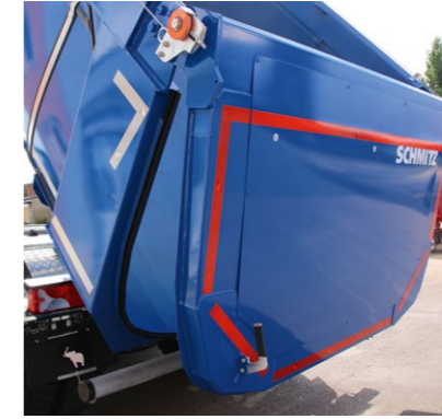
Aufliegende Rückwandklappe mit umlaufender Gummidichtung.
