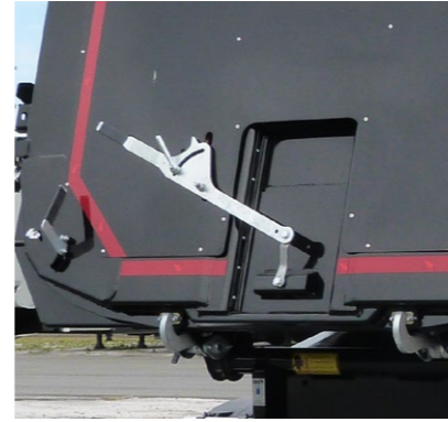
Schieber mittig: bei aufliegender Rückwandklappe für dosierte Entladung (Option).
