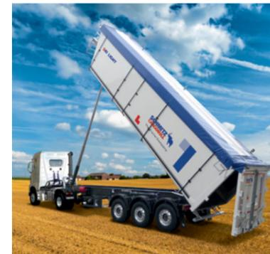
**Bogenförmiges Rollverdeck** für ein einfacheres Handling. Das Schließen erfolgt vom Boden aus mit dem langen Mittelspangurt.
