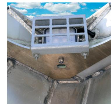
**Innenraumbeleuchtung** für Aluminium-Volumen-Mulden ermöglicht die Reinigung oder das Handling mit palettierter Fracht auch bei geschlossenem Verdeck.
