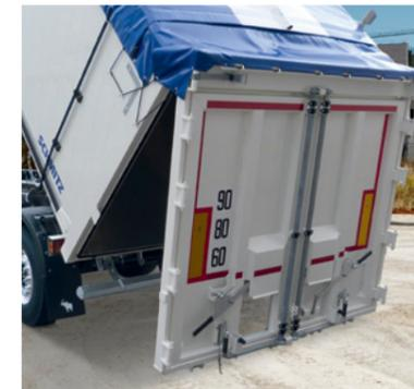
**Das Entleeren mit geschlossener Plane** über die Pendelfunktion der Kombitür spart Zeit beim Abladen.
