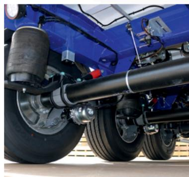
**Gewichtsoptimiertes ROTOS-Fahrgewerk** mit niedrigerer Bauhöhe, Scheibenbremse mit 430 mm Durchmesser und Luftfederung.
