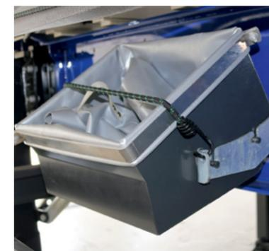
**Getreideauslauftrichter** für Getreideschieber mit praktischer Parkposition am Chassis und geschützt im Staukasten.
