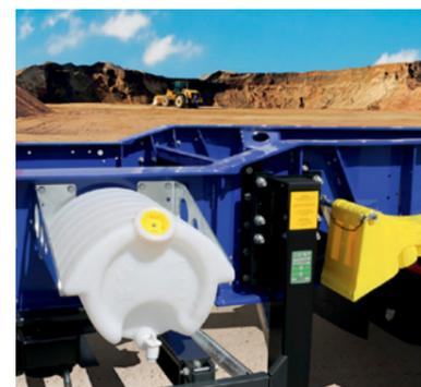
**Die Kröpfung im Halsbereich** des Fahrgestells (Stepframe) ermöglicht eine reduzierte Ladehöhe.
