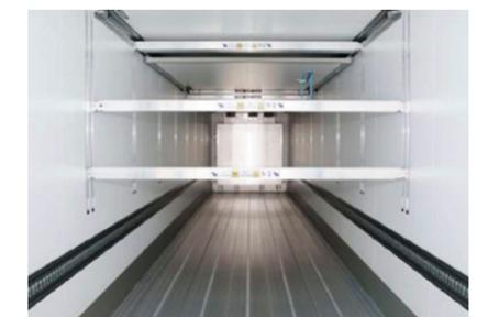
**Der Multifunktionsboden ist dank der verschweißten Bodenwanne einfach zu reinigen.** Der Boden ist PIEK zertifiziert, hat eine längere Lebensdauer, ist rutschfester und gleichzeitig leichter.
