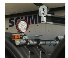
LED Lichtpaket: LED-Heckleuchten und vier Rückfahrscheinwerfer am Heck und seitlich über dem Fahrwerk.
