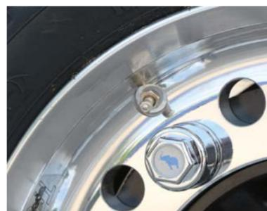
**Reifendruck-Kontrollsystem** vermindert Verschleiß der Reifen, senkt die Kraftstoffkosten und reduziert die Gefahr einer Panne.
