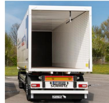
**Geöffnetes Rolltor\*** im Wechselkoffer für schnelle Verladezyklen, den schnellen Zugang an der Rampe und in engen Platzverhältnissen.
