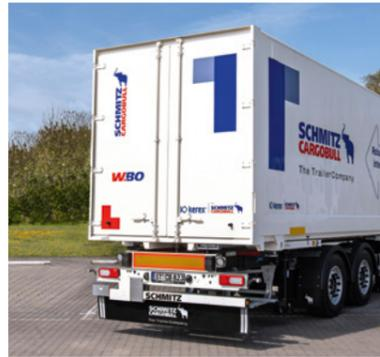
**Doppelflügeltür** mit robusten, außen liegenden Drehstangenschlüssen. Im geöffneten Zustand werden die Türen mit einer Kette gesichert.
