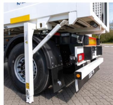
**Vier Stützbeine mit diagonaler Sicherung nach DIN EN 284** (als Standardausführung mit fester Aufsattelhöhe von 1.320 mm). Vier Aufnahmen zur Sicherung mit Twist-Locks entsprechend dem Codierungsprofil C30.
