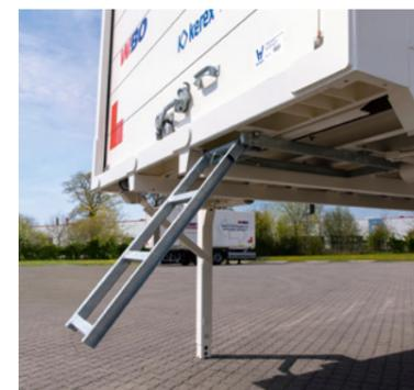
**Klappleiter aus verzinktem Stahl** für den Zugang zum Laderaum.
