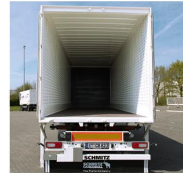
**Geöffnete Doppelflügeltür** mit einem Öffnungswinkel von 270°. Eng anliegend an der Seitenwand für eine gute Rangierfähigkeit.
