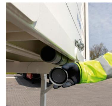
**Dokumentenrohr\*** für Begleitpapiere an der Heckunterseite montiert.
