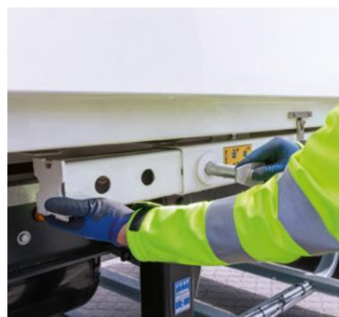
**Einstellen des teleskopierbaren Stützbeins\*** für die Aufsattelhöhen von 1.120 mm, 1.220 mm und 1.320 mm.
