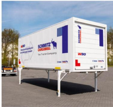
**Abgesetzte Wechselbox W.BO** in robuster Stahlbauweise mit bahnfähigem Rolltor\*. Der Wechselbehälter ist ideal für den Einsatz im KEP-Transport, im Begegnungs- und Intermodal-verkehr.
