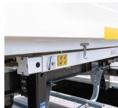
**Stützbein 90°** in Transportstellung mit Sicherung.
