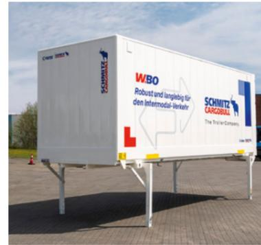
**Glatte Stirn- und Seitenwände** für individuelle Beschriftungen. Für den intermodalen Bahn-transport sind die Wechselboxen W.BO mit Greifkanten ausgestattet.
