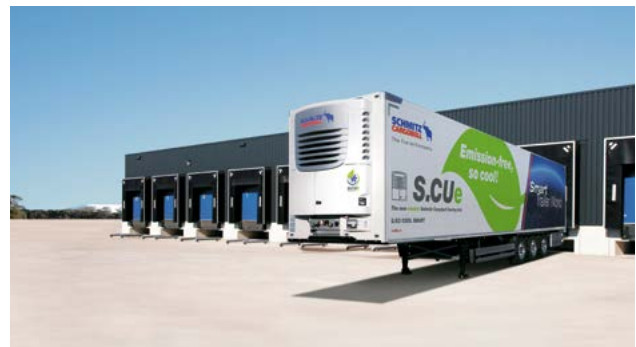
Vollelektrischer Kühlkoffer mit elektrischer Transportkältemaschine für die emissionsfreie und leise Belieferung von Supermärkten
