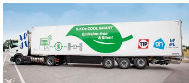
Vollelektrischer Kühlkoffer S.KOe COOL SMART: Die elektrifizierte Trailerachse rekuperiert Energie und verringert die Nachladezeit der Batterie des Kühlgeräts.
