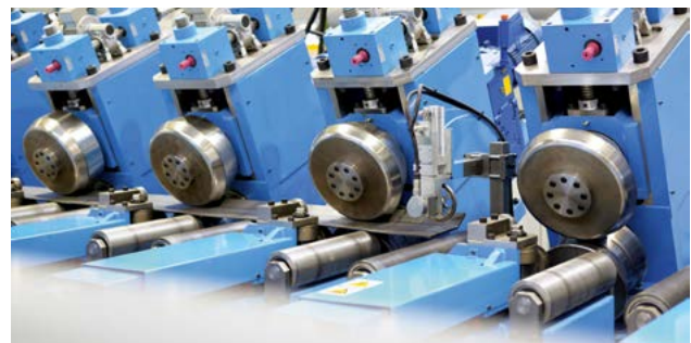
Langträgerfertigung: Die verzinkten Langträger für Curtainsider und Trockenfrachter werden ohne Schweißen kaltgeformt.
