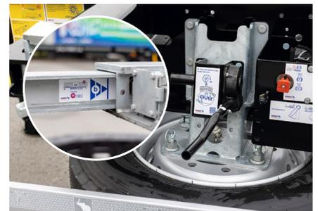
**Neue Kennzeichnung** an Verriegelungen und Ausschüben für die sichere Identifikation der unterschiedlichen Ladepositionen, unterstützt durch Ladeplan und Bedienvideos via QR-Code.
