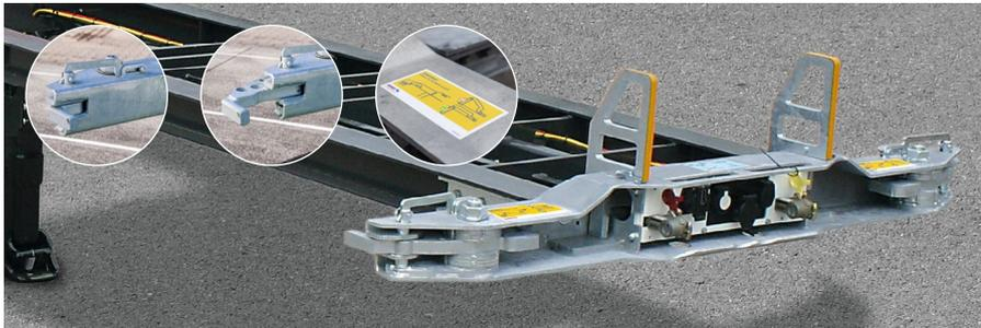
**PIN Verriegelung** am Frontbalken zur Sicherung von 40 und 45 Fuß Container mit Tunnel.
