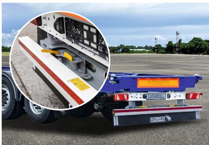
Neu konstruiert: **Ausziehbarer Unterfahrerschutz** für 45' Container ist einfacher und sicherer im Handling und ohne lose Teile, die verloren gehen können.
