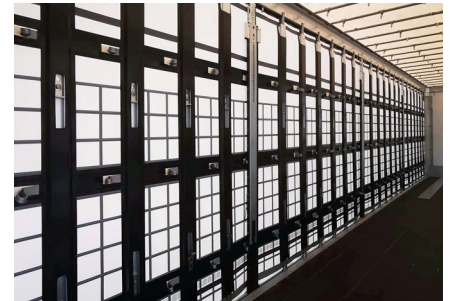
POWER CURTAIN PLUS: Ohne zusätzliche Hilfsmittel formschlüssige Beladung von Reifen und anderen nicht formstabilen Gütern.
