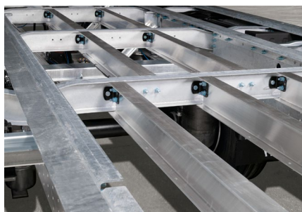
Rolliertes MODULOS-Chassis: Korrosionsbeständig und reparaturfreundlich dank der gebolzten und feuerverzinkten Technologie.
