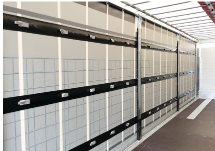
POWER CURTAIN: Aufbau ohne Aufsatzlatten für verkürzte Be- und Entladezeiten und mehr Arbeitssicherheit.
