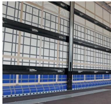
**POWER CURTAIN:** Aufbau ohne Aufsatzlatten und Lattentaschen für verkürzte Be- und Entladezeiten.
