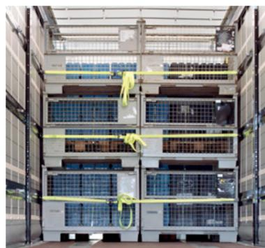
**Rückwärtige Ladungssicherung bei Teilladungen** mit den integrierten Planen-Schlaufen z. B. für Spanngurte oder Sicherungsplanen. In drei Reihen übereinander haben die Schlaufen eine Sicherungskraft von bis zu 7.500 daN bei Teilladung (pro Reihe 2.500 daN).
