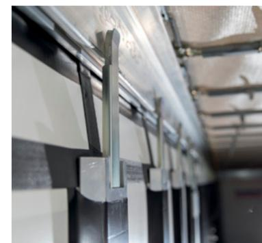
**Oben fixiert:** Ausschiebbare Metallzungen greifen hinter das Dachprofil um das Auslenken der Supporting Bars\*\* zu verhindern.
