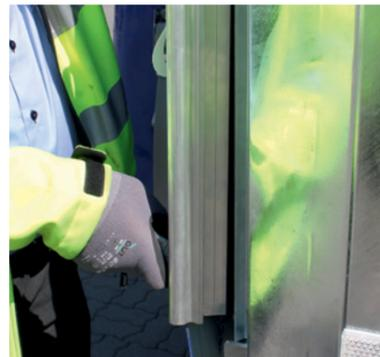
**Hakleiste an der Stirnwand** zum Einhängen der Plane in die verstärkte Kante, für eine höhere Spannkraft.
