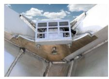
Innenraumbeleuchtung für Aluminium-Volumen-Mulden ermöglicht die Reinigung oder das Handling mit palettierter Fracht auch bei geschlossenem Verdeck und sorgt für eine bessere Ausleuchtung bei Nachtbetrieb.
