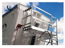
Sicher und praktisch: Die höhenverstellbare, stirnwandmontierte Arbeitsbühne mit rutschhemmendem Boden, Mulden-Einstiegshilfe und Parkposition für den Hydraulikschlauch.
