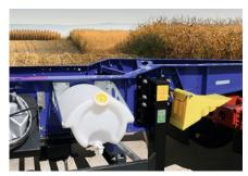
**Die Kröpfung im Halsbereich** des Fahrgestells (Stepframe) ermöglicht eine reduzierte Ladehöhe.
