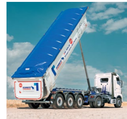
Schiebeverdeck von Schmitz Cargobull ermöglicht zeitsparendes Öffnen und Schließen. Wahlweise in manueller oder elektrischer Ausführung bedienbar per Fernbedienung.
