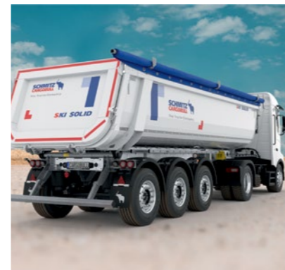
Rollplane als einfache und kostengünstige Muldenabdeckung gegen Nässe und Verwehungen. Reduziert den Luftwiderstand.
