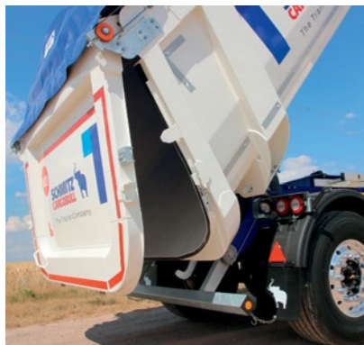
Aufliegende Pendelklappe ist geeignet für Teilentladungen. Optional mit Schieber.
