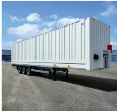
**Schiffscontainer-Aufbau** für den Ferry-Verkehr und zum Schutz der Ware gegen Diebstahl. Die integrierte robuste Sockelscheuerleiste reduziert Beschädigungen am Container beim Be- und Entladen.
