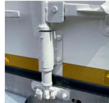
**Robustes Schloss-System** für die Hecktür, 2 Drehstangenverschlüsse je Tür.
