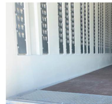
**Langlebiger und robuster Siebdruckboden** bis 8.000 kg\* Staplerachslast nach DIN 283. Durch versiegelte Bodenplatten gelangt von unten keine Feuchtigkeit an die Fracht. Eingelassenes Verschleißblech\* schützt den Boden am Heck.
