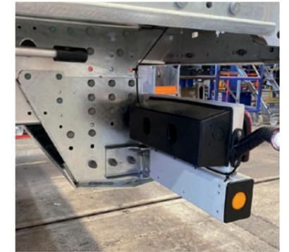
**Extra verstärkte Unterfahrtschutzkufe\*** für Mega Bereifung in Verbindung mit Ferry-Ausstattung.
