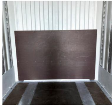
**Stahl-Stirnwand mit Schichtholzplatte\***: Schutz für Fracht und Trailer.
