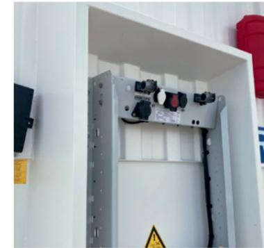
**Zusätzlicher Schutz für Licht und Bremsanschluss** ideal für unbegleiteten Ferry-Verkehr.
