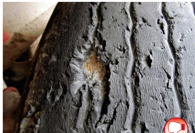
Reifen mit Laufflächenausbrüchen
