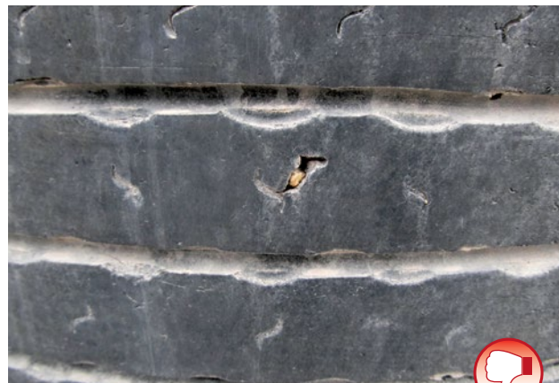
Reifen mit Fremdkörper
