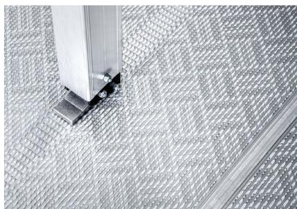
Multifunktionsboden\* mit optimierter Rutschfestigkeit, einfacher Ladungssicherung beim Fixieren von senkrechten Teleskopbalken sowie hygienischer Reinigung.
