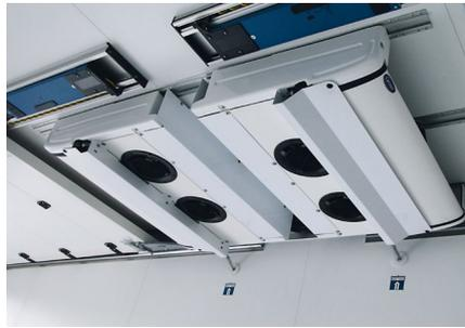
Decken-Zusatzverdampfer\* für MultiTemp-Ausführungen und Anhänger in Durchladezügen.
