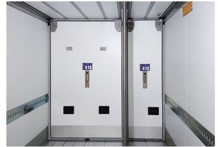
Verschiebbare Trennwand aus dampfdiffundiertem FERROPLAST®: Schnelle, variable MultiTemp-Aufteilung; wahlweise für 1/3- und 2/3-Teilung oder als durchgehende Wand lieferbar.
