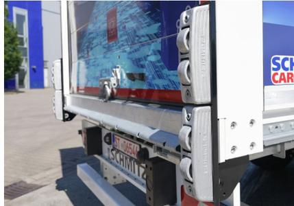
**Heavy Duty Heckpaket:** Delta Rammleiste und 2 Paar Duo-Rollen aus Stahl am Heck bieten erhöhten Schutz für den Trailer im Verteiler- oder Hubbetrieb.
