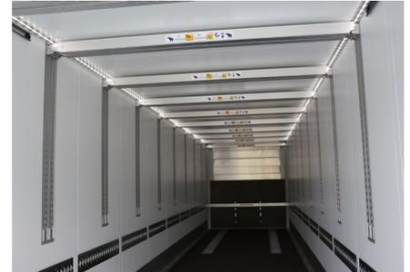
**Extra helle LED-Innenbeleuchtung** in voller Aufbauhöhe auf einer oder beiden Seiten für mehr Sicht im Innenraum.
